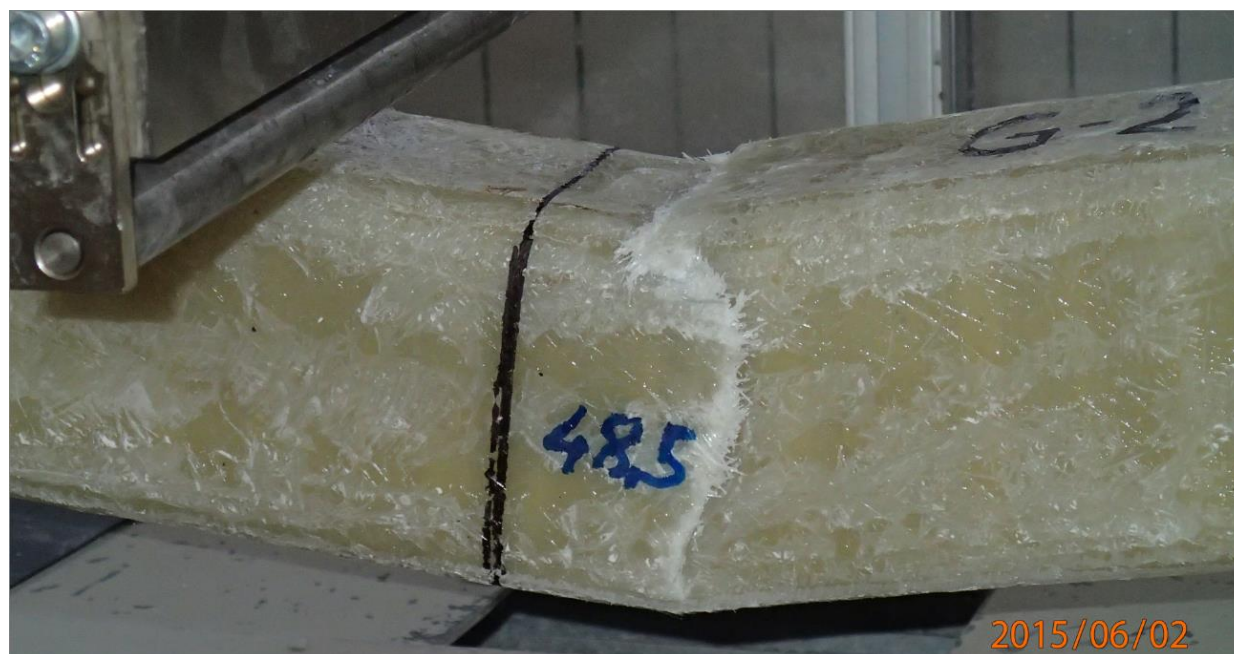
Fotografija 2.18 Prikaz pukotina
