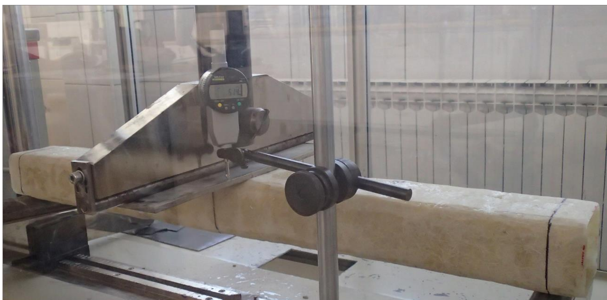
Fotografija 2.3 Prikaz postavljanja mikrouređaja na mjerno mjesto
