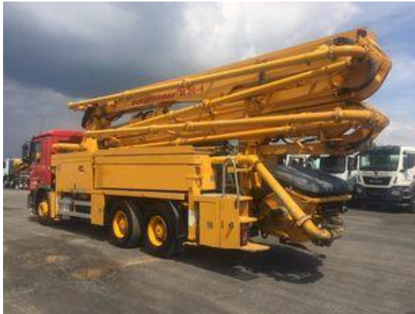
Slika 3.11. Pumpa za beton Mercedes-Benz Actros 2641
