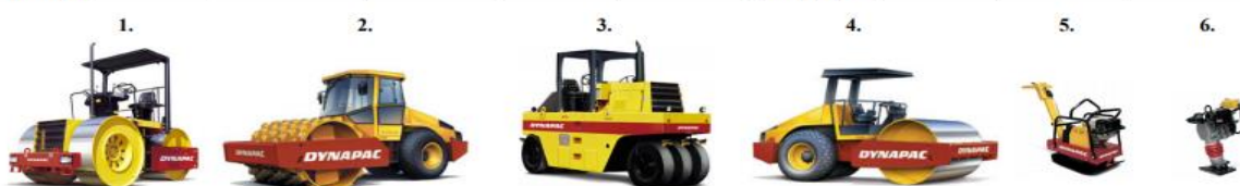
Slika 3.2. Odabir vrste valjka ovisno o materijalu koji se zbija
