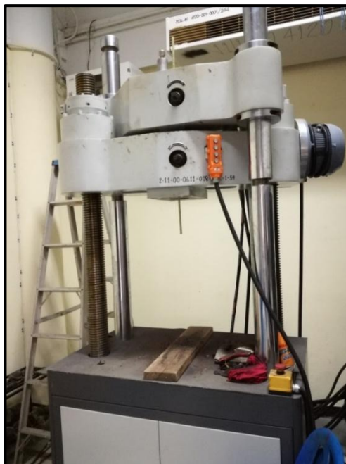
Slika 4. Prikaz kidalice sa postavljenim testnim uzorkom
