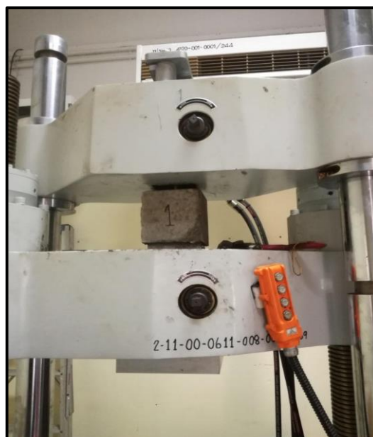
Slika 54. Prikaz stroja za Pull-out ispitivanje
