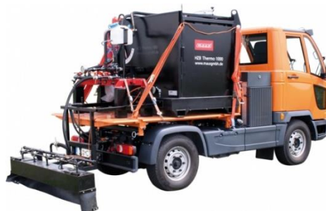
Slika 16. Stroj za prskanje emulzije [17]
