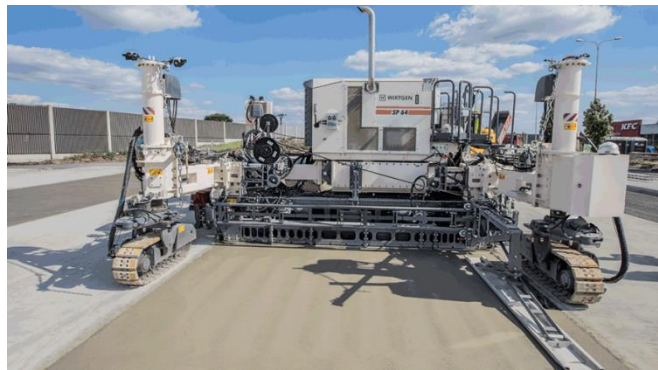
Slika 14. Finišer za beton [15]
