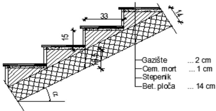
$$\operatorname{tga} = v_{st} / s_{st} = 17/29 = 0,586 ; \alpha = 30,4^\circ$$
