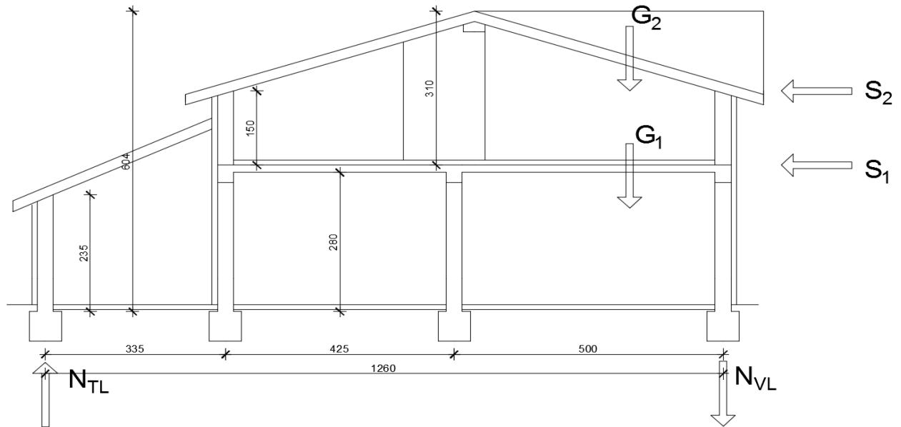
Potresne sile proračunate su po pojednostavljenom postupku. Građevina se nalazi u području Solina za koje se uz povrtni period od 475 godina očekuje potres sa ubrzanjem tla  $a_g=0.2g$ . Građevina je temeljena na stjenovitom tlu, dakle pripada klasi tla A, pa slijedi:
