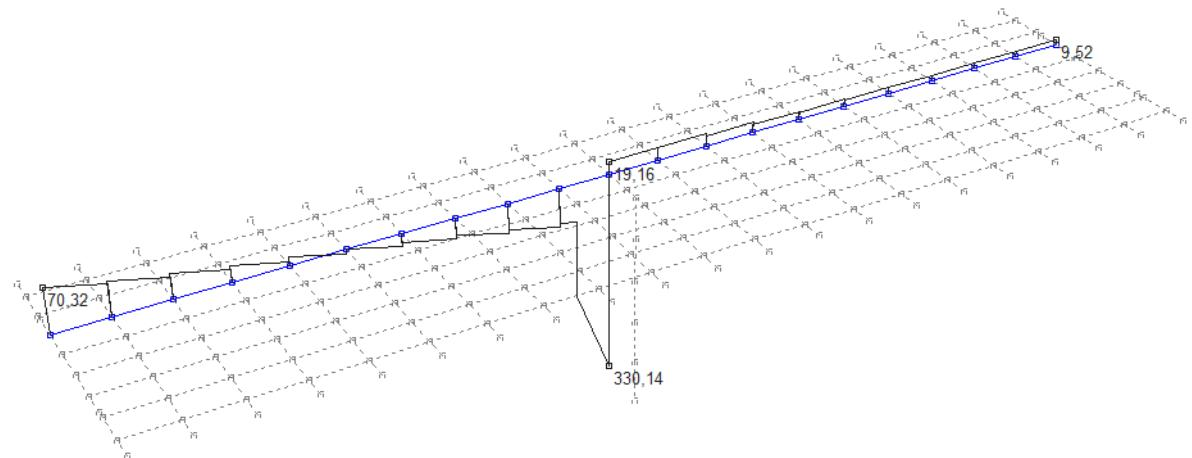
Slika 23: Pokretno opterećenje – maksimalne poprečne sile pri stupu – poprečne sile  $T_z$  (kN)
