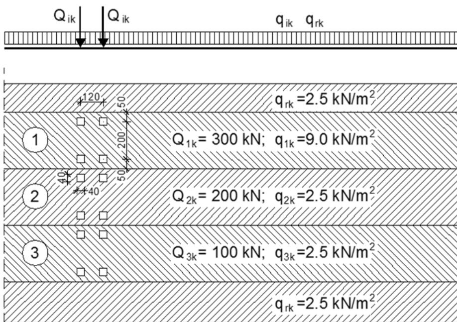
Slika 11: Prikaz načina opterećivanja mosta pokretnim opterećenjem
