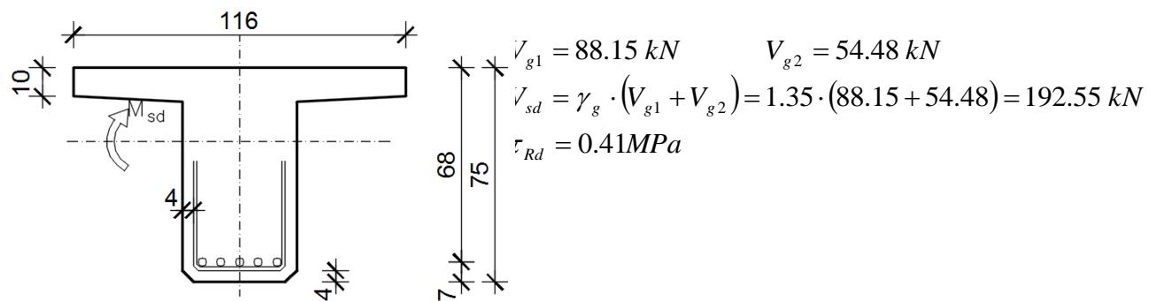
Dio poprečne sile koju preuzima beton i uzdužna armatura:
