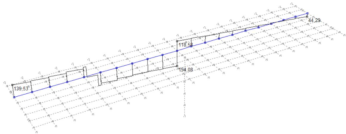
Slika 17: Pokretno opterećenje – maksimalni momenti pri stupu – poprečne sile  $T_z$  (kN)
