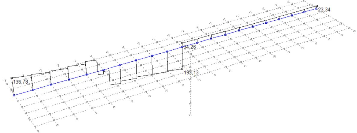
Slika 14: Pokretno opterećenje – maksimalni momenti u prvom polju – poprečne sile  $T_z$  (kN)
