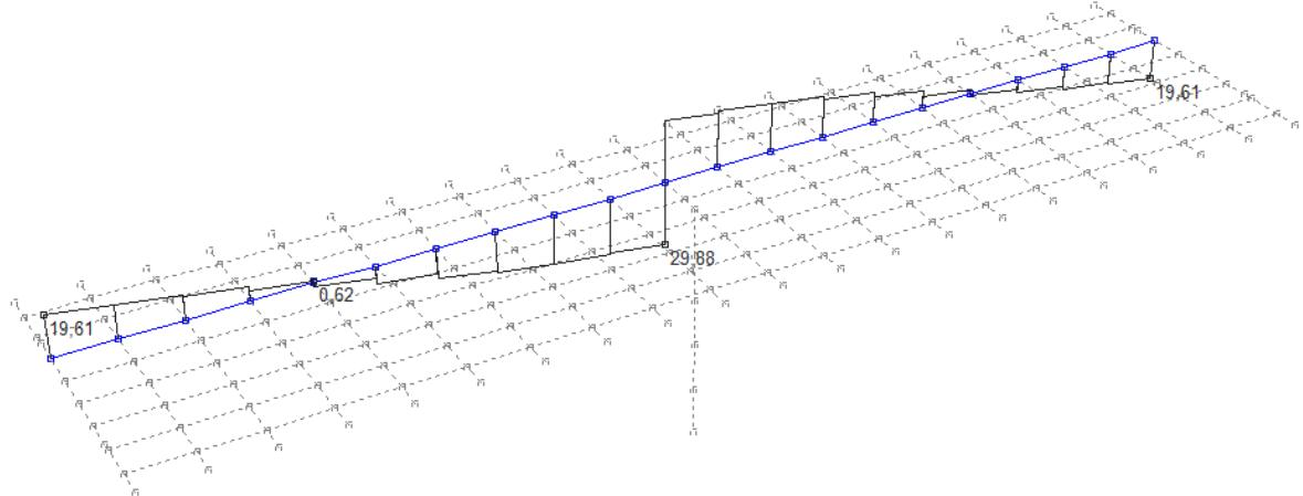
Slika 10: Dodatno stalno opterećenje – Poprečne sile  $T_z$  (kN)
