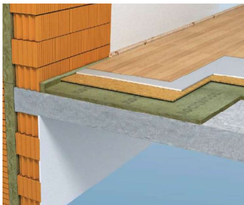
Slika 3.1 Shema međukatne konstrukcije
