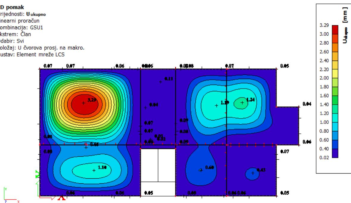
*Slika 5.9 Progib ploče (mm) za kombinaciju GSU-1*
