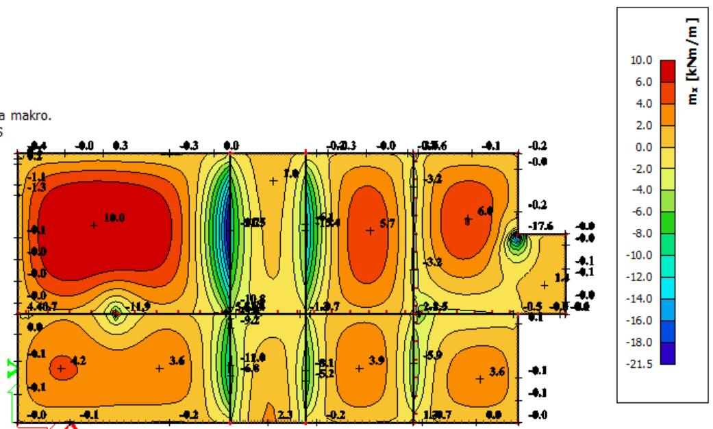
Slika 6.10 Moment savijanja  $M_{Ed,x}$  (kNm/m) za GSU-I
