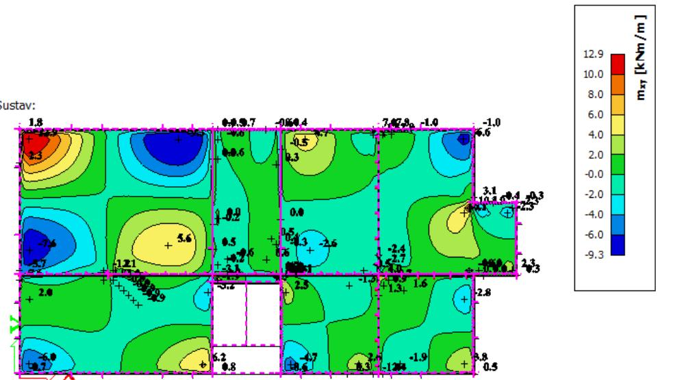
Slika 5.4 Moment savijanja  $M_{Ed,xy}$  (kNm/m) za GSN-1
