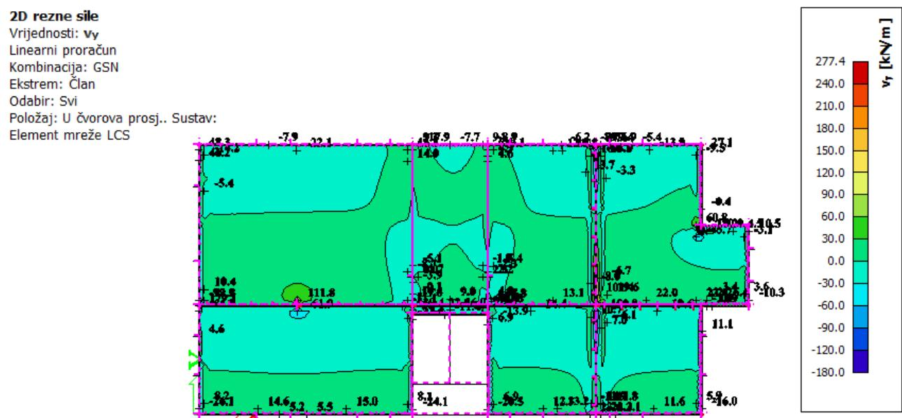
Slika 5.6 Poprečne sile  $V_{Ed,y}$  (kN/m) za GSN-1
