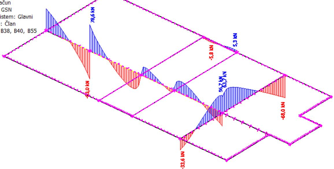
Slika 7.5 Poprečne sile  $V_{Ed,z}$  (kN) za GSN-1
