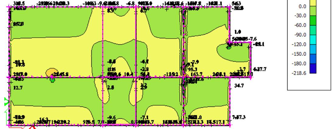
*Slika 6.5 Poprečne sile  $V_{Ed,y}$  (kN/m) za GSN-1*
