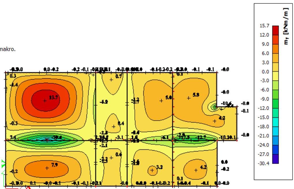
Slika 6.11 Moment savijanja  $M_{Ed,y}$  (kNm/m) za GSU-I
