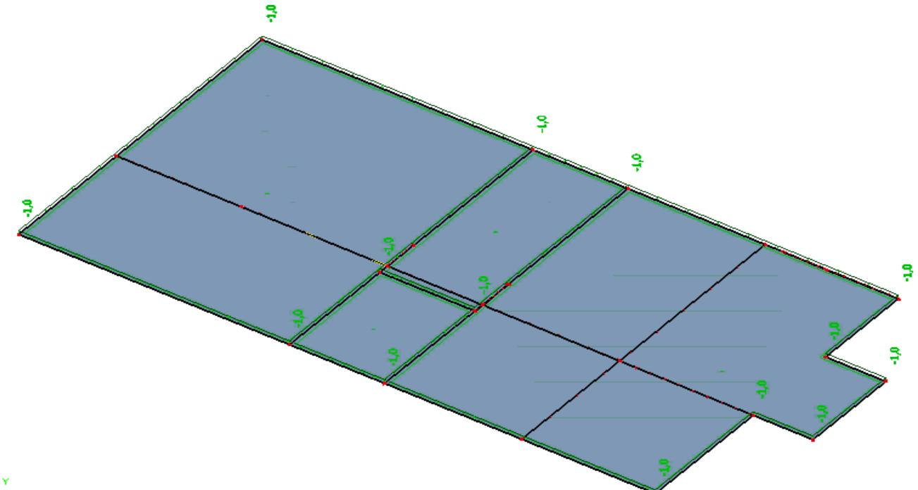
Slika 3.6 Promjenjivo djelovanje  $Q1$  na krovu ( $\text{kN}/\text{m}^2$ )
