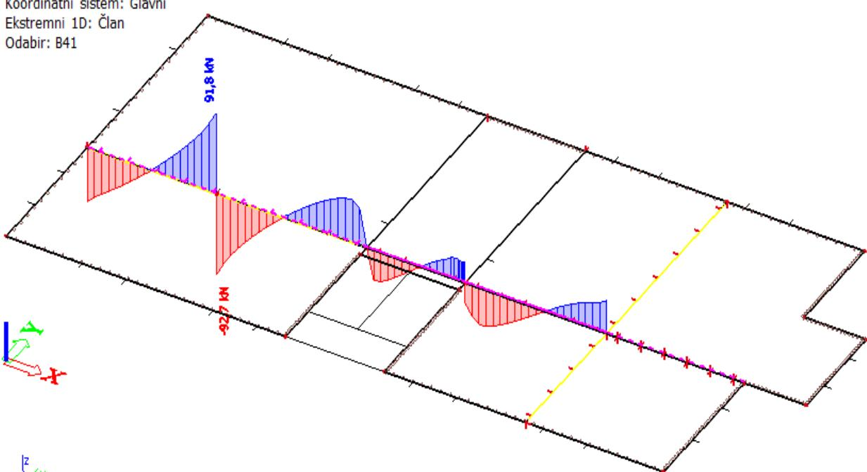
Slika 7.2 Poprečne sile  $V_{Ed,z}$  (kN) za GSN-1
