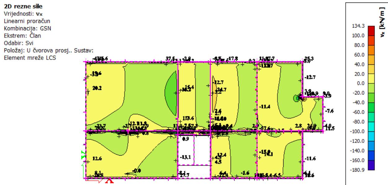
Slika 5.5 Poprečne sile  $V_{Ed,x}$  (kN/m) za GSN-1
