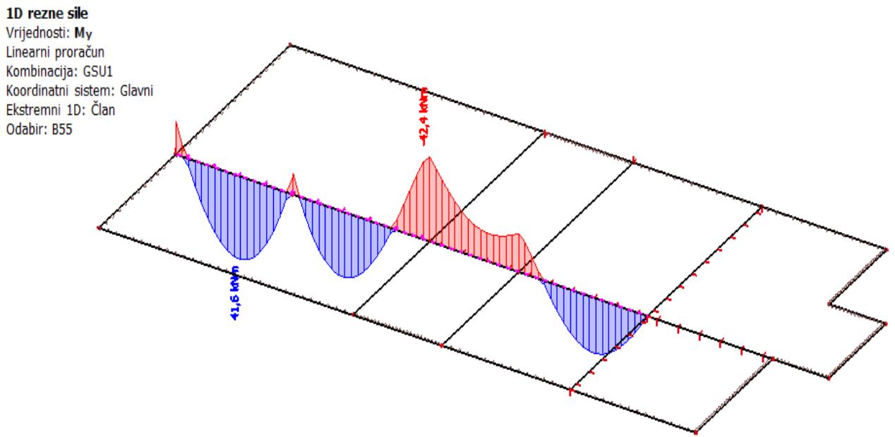
Slika 7.7 Moment savijanja  $M_{Ed,y}$  (kNm) za GSU-1
