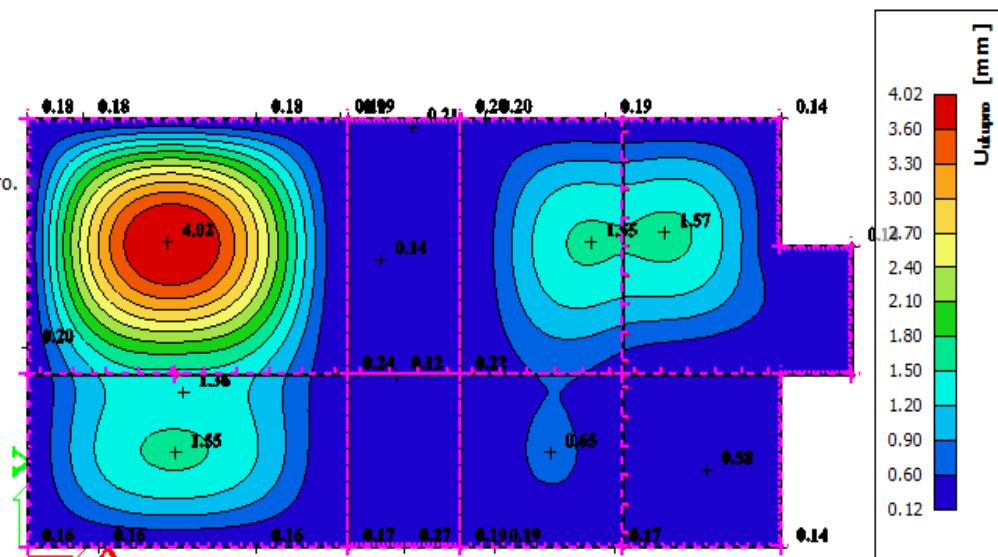
*Slika 6.9 Progib ploče (mm) za kombinaciju GSU-2*
