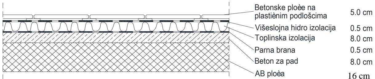
Slika 3.4 Grafički prikaz slojeva konstrukcije neprohodnog ravnog krova
