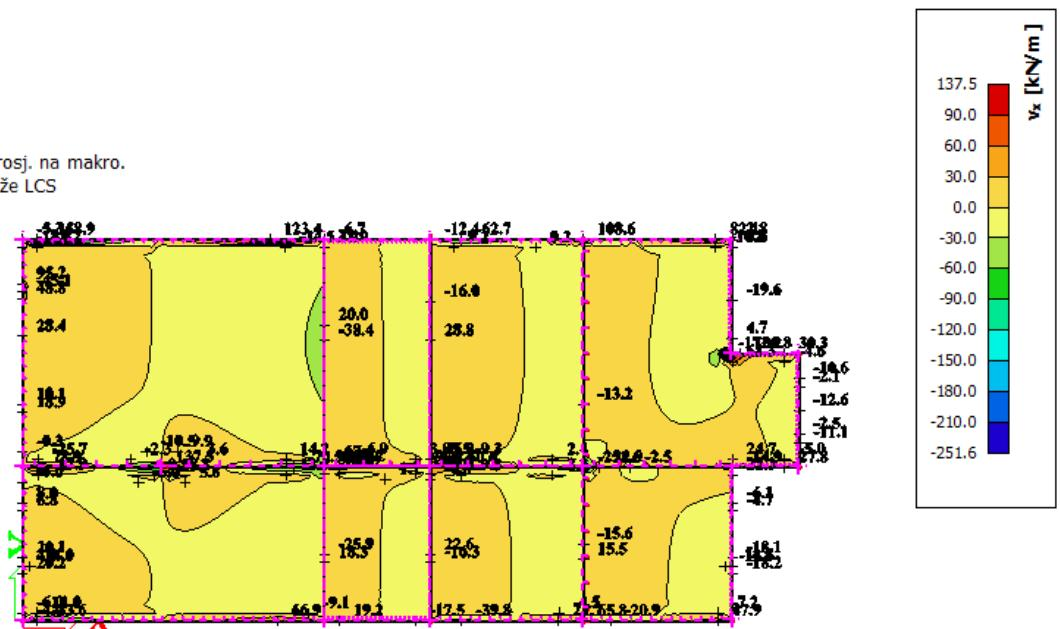
Slika 6.4 Poprečne sile  $V_{Ed,x}$  (kN/m) za GSN-1
