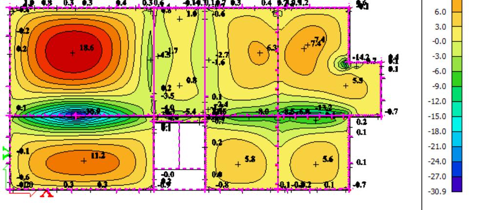
Slika 5.3 Moment savijanja  $M_{Ed,y}$  (kNm/m) za GSN-1**2D rezne sile**Vrijednosti:  $m_{xy}$
