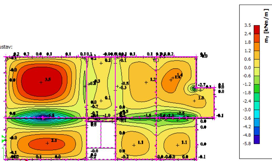
Slika 5.8 Armatura u ploči smjer  $As,y-y$  (polje) ( $cm^2/m$ ) za GSN-1
