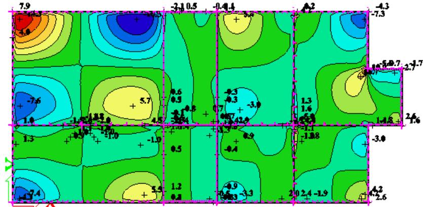
Slika 6.3 Moment savijanja  $M_{Ed,xy}$  (kNm/m) za GSN-1
