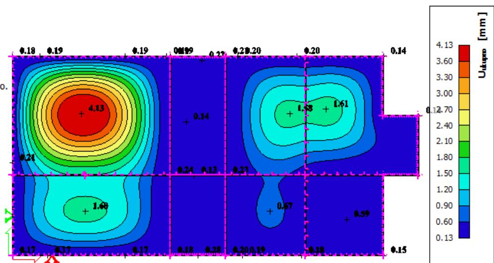
*Slika 6.8 Progib ploče (mm) za kombinaciju GSU-1*
