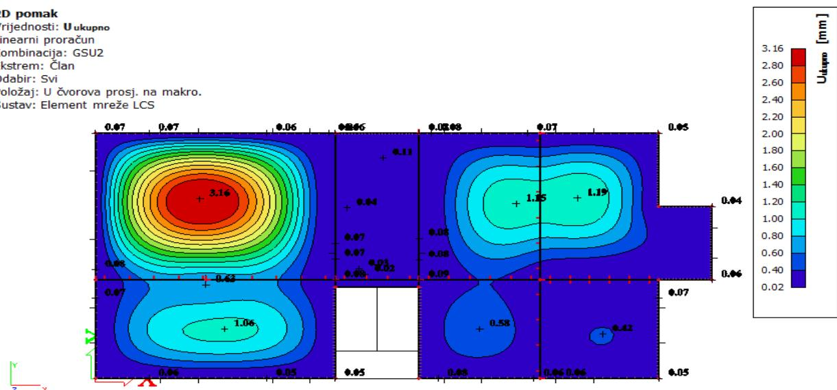
*Slika 5.10 Progib ploče (mm) za kombinaciju GSU-2*
