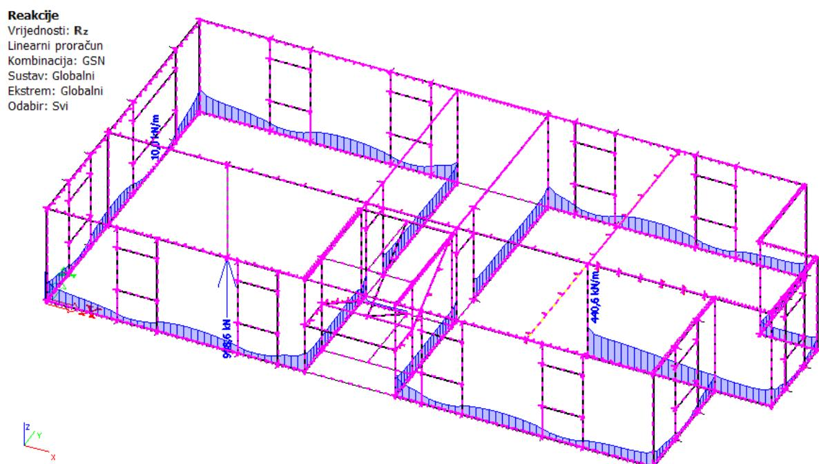
*Slika 9.1 Linijske reakcije na mjestima oslanjanja zidova na temeljne trake [kN/m] za kombinaciju GSN-I*
