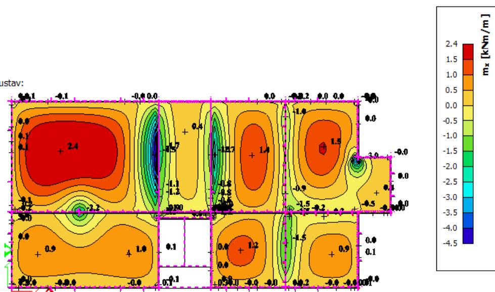
Slika 5.7 Armatura u ploči smjer  $As,x-x$  ( $kNm/m$ ) za GSN-1
