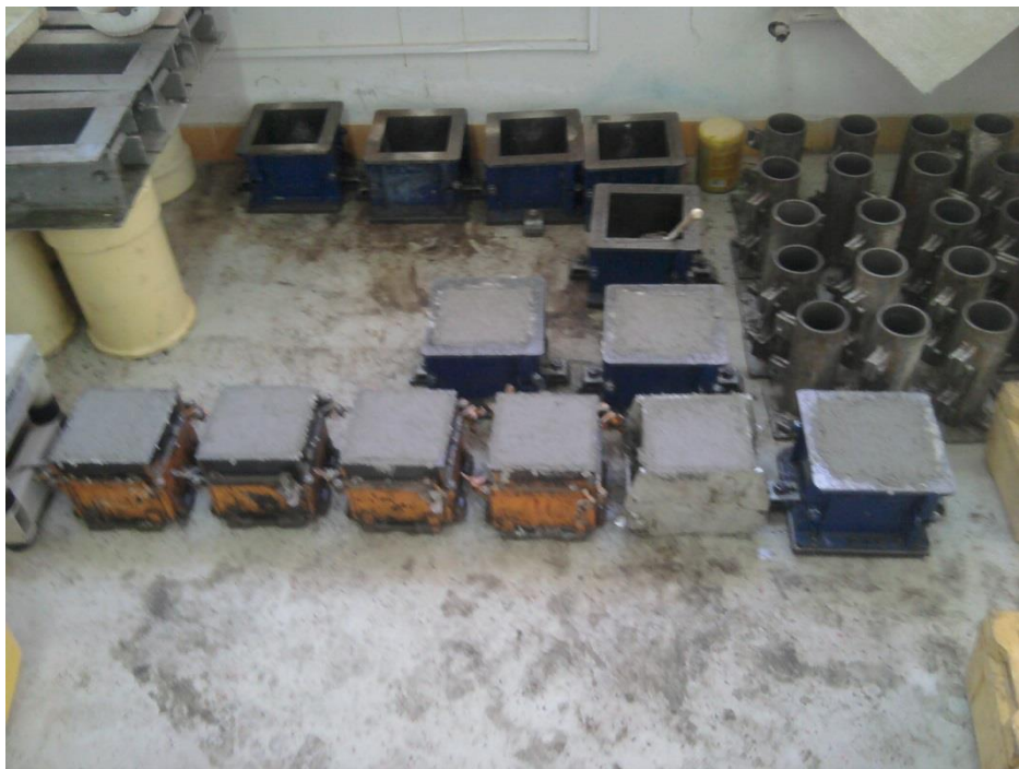
Slika 9.5. Ugrađeni uzorci betona [slika zabilježena tijekom ispitivanja]
