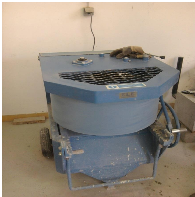
Slika 9.1.Laboratorijska miješalica[slika zabilježena tijekom ispitivanja]
