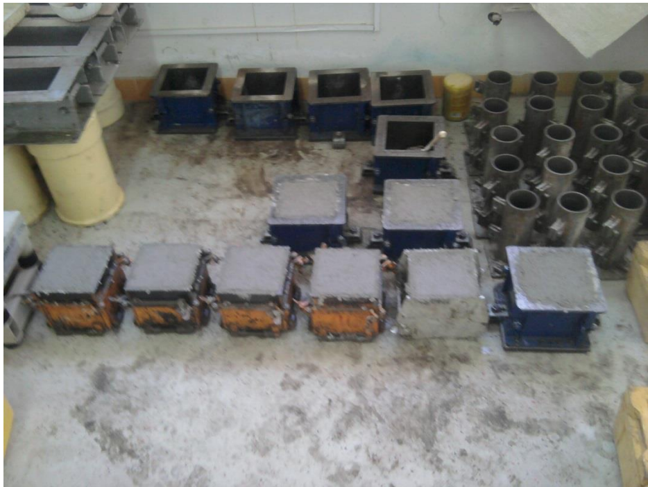
Slika 9.5. Ugrađeni uzorci betona [slika zabilježena tijekom ispitivanja]
