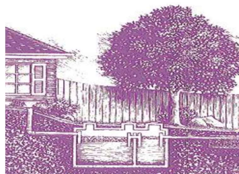
Slika 2.2 Shema dvodjelne septičke jame
