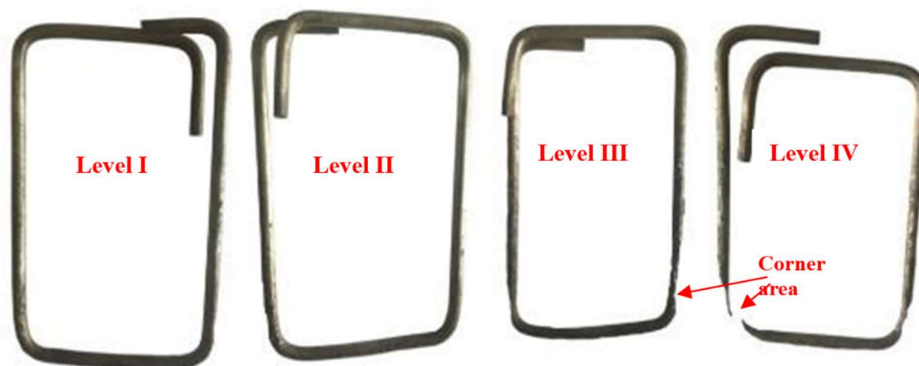
Slika 7.113. Prikaz oštećenja vilica u eksperimentalnim istraživanjima[14]
