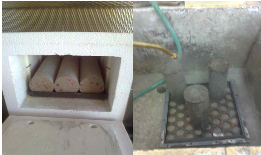
Slika 5.4 Uzorci u peći i u fazi hlađenja vodom[5]
