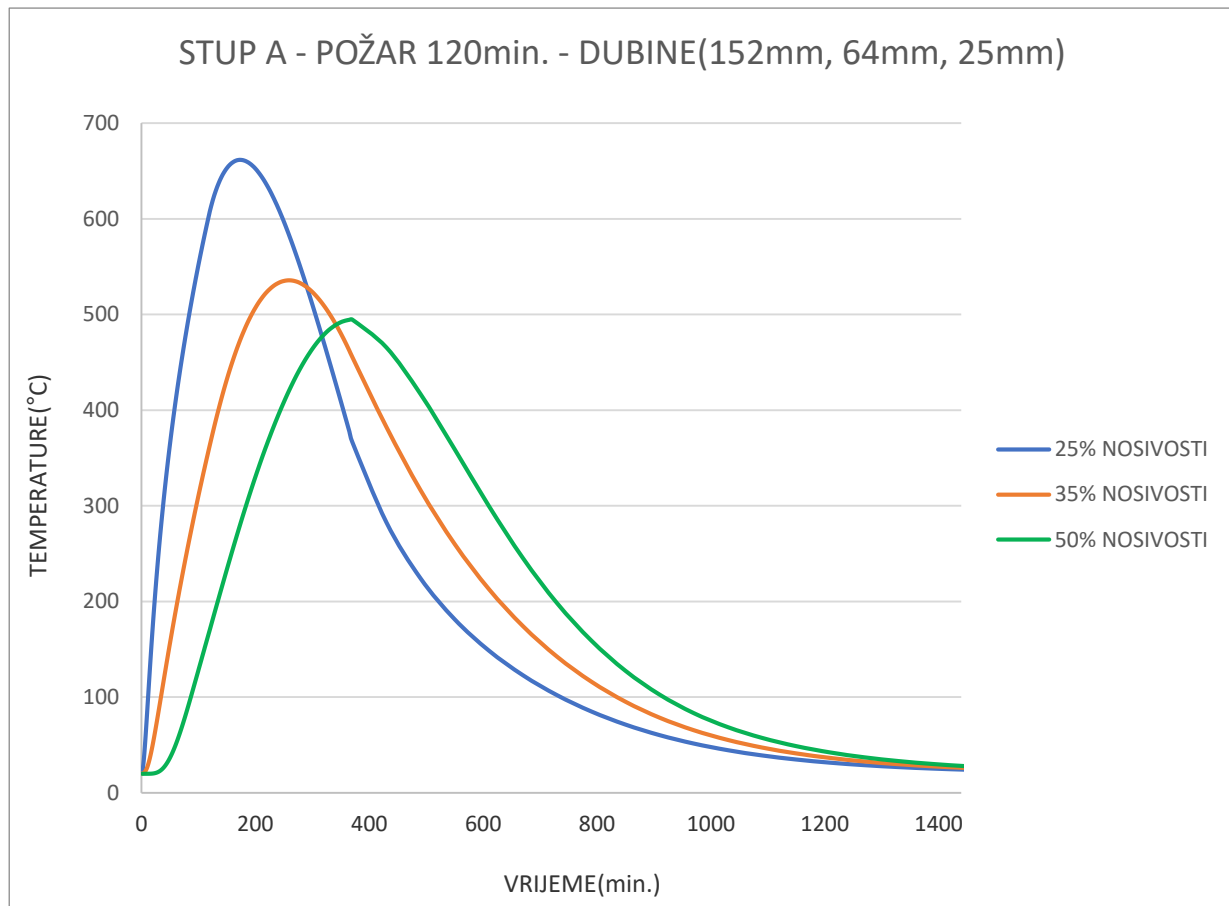
Slika 6.282: Prikaz dijagrama distribucije temperature za vrijeme požara od 120 minuta
