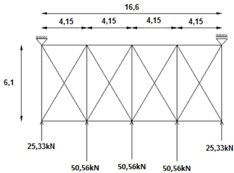
*Slika 2.2.2.1. Raspored krovnih spregova i opterećenje*
