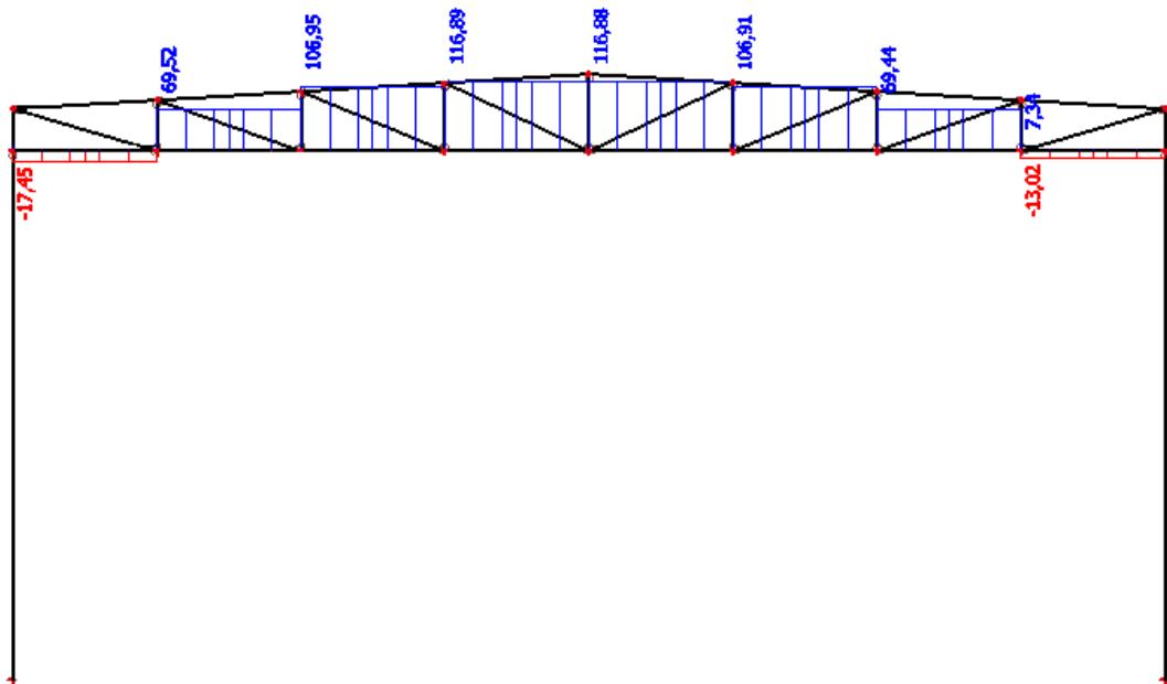
Slika 5.1.2.2. Maksimalna tlačna uzdužna sila u donjem pojusu rešetke
