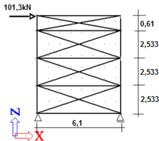
Slika 5.2.4.1. Raspored bočnih spregova i opterećenje
