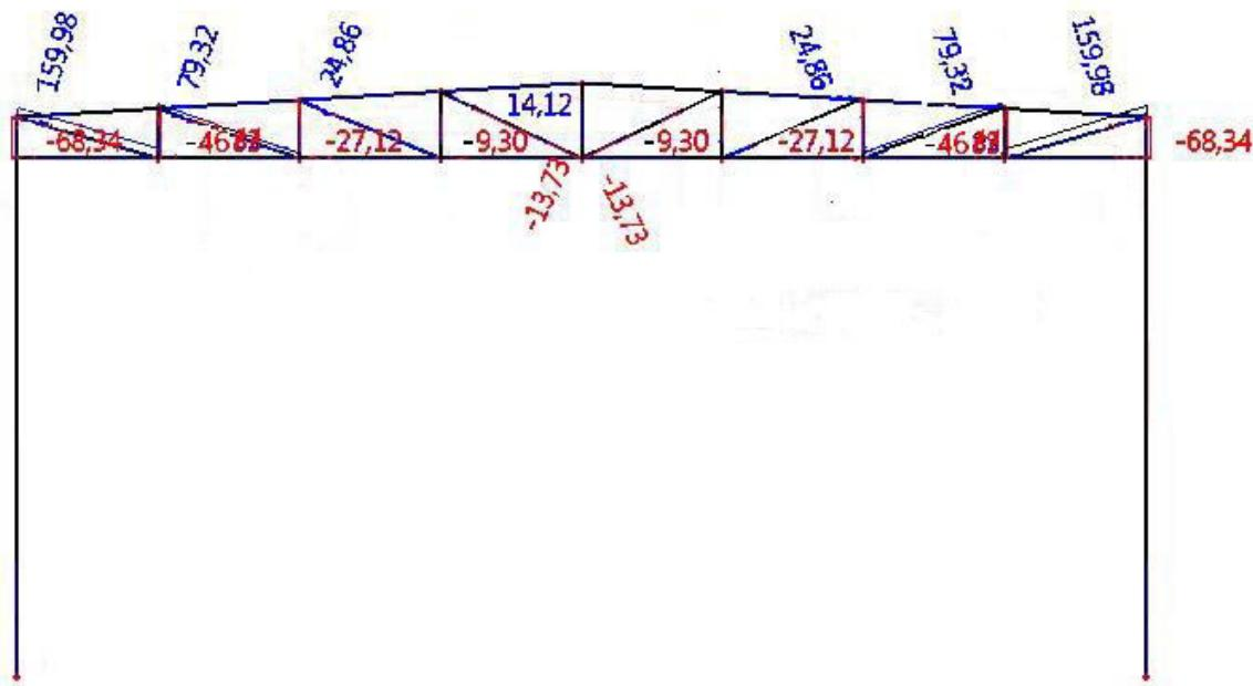
Slika 5.1.2.4. Maksimalne uzdužne sile u vertikalama i dijagonalama
