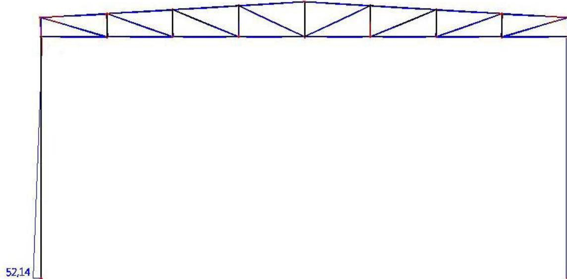
Slika 3.5.2. Dijagram poprečnih sila opterećenja vjetrom W2
