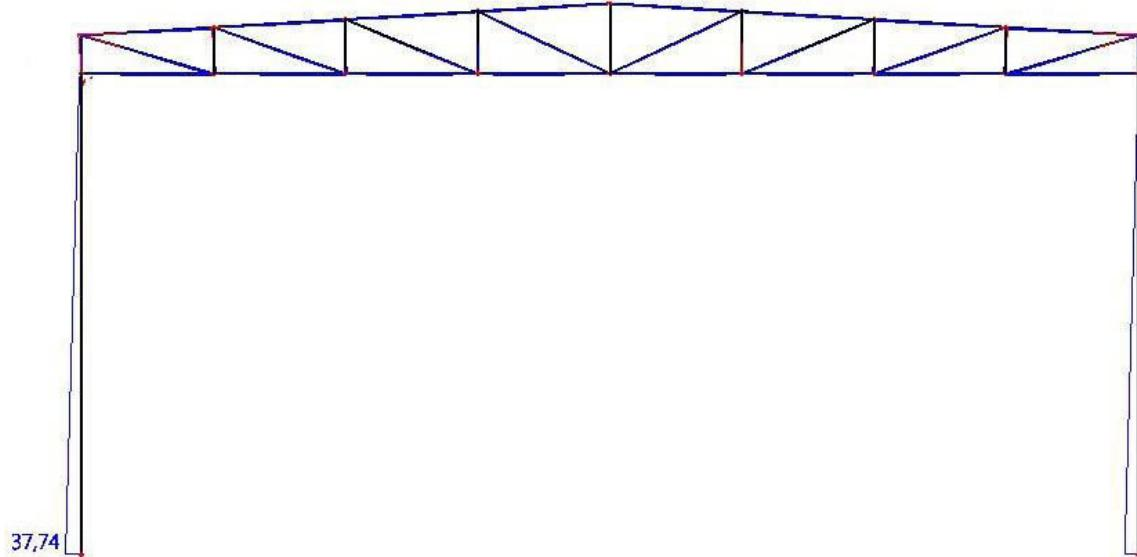
Slika 3.4.2. Dijagram poprečnih sila opterećenja vjetrom W1
