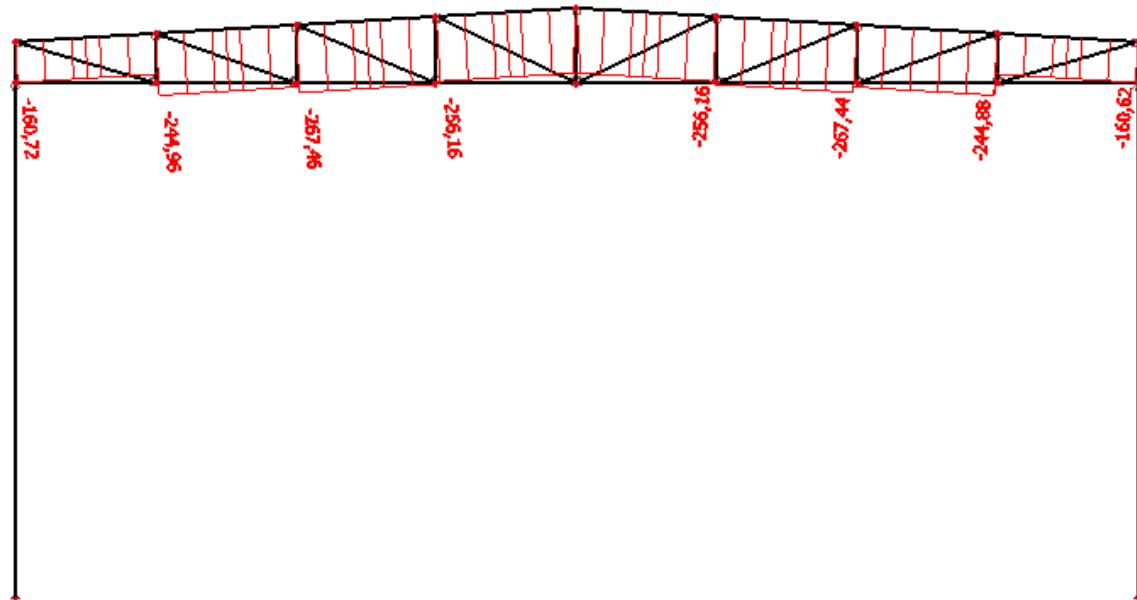
Slika 5.1.2.3. Maksimalna tlačna uzdužna sila u gornjem pojusu rešetke
