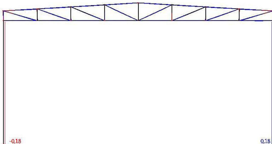
Slika 3.1.2. Dijagram poprečnih sila vlastite težine konstrukcije
