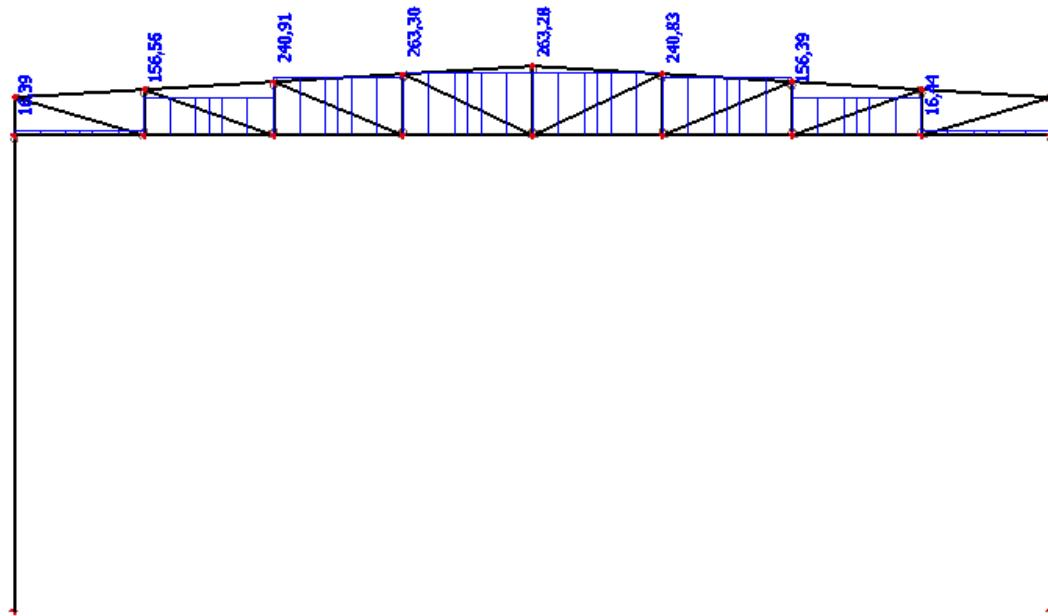
Slika 5.1.2.1. Maksimalna vlačna uzdužna sila u donjem pojusu rešetke
