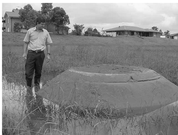
Slika 8.39 Stožac tla na mjestu početka povratne erozije u zaobalju (Fell, 2005.)
