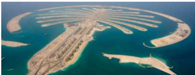
Slika 3.14 Umjetni otoci (otoci Palmi) nastali nasipavanjem u more.
