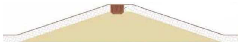
Slika 9.13 Popravak krunice iskopom i ponovnim zbijanje prikladnijim gradivom
