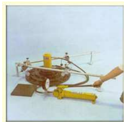
Slika 5.6 Oprema za ispitivanje probnom pločom
