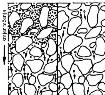
Slika 8.47 Lijevo model tla s previše sitnih čestica, desno za slabo graduirano tlo
