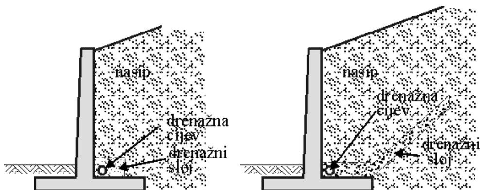
Slika 3.49 Drenaže konzolnih potpornih zidova
