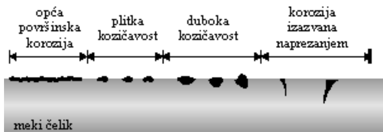
Slika 7.144 Vrste korozije na čeličnoj šipci
