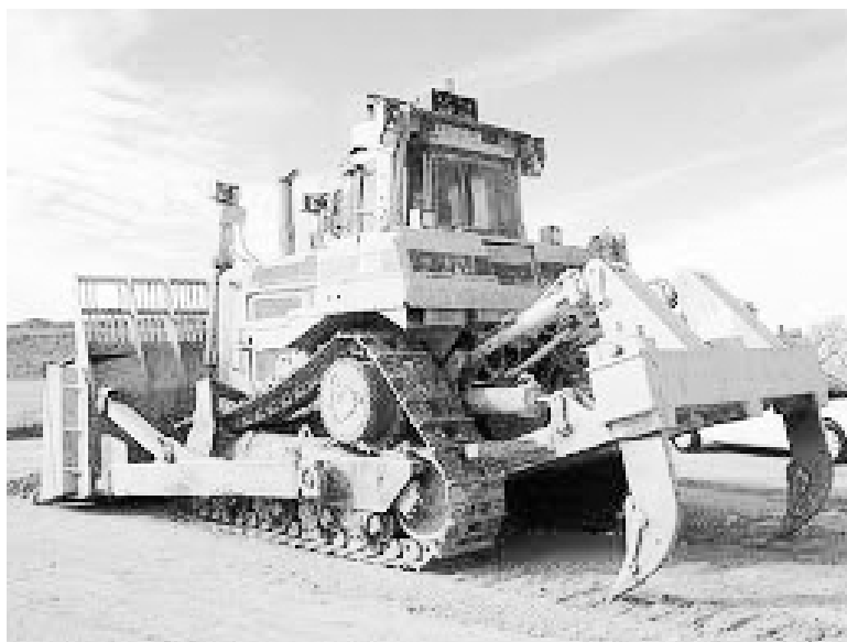
Slika 8.10 Buldozer na gusjenicama s rijačem za ripanje sa stražnje strane
