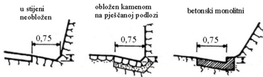
Slika 13.6 Rigoli u nožici pokosa usjeka ili zasjeka
