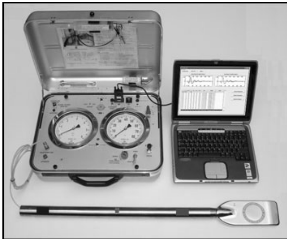
Slika 3.28 Oprema za ispitivanje dilatometrom s pripadnim sustavom za praćenje pokusa i bilježenjem rezultata.
