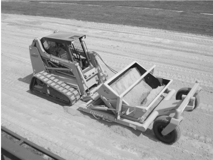
Slika 10.9 Skreper vučen traktorom na gusjenicama, prilikom razastiranja
