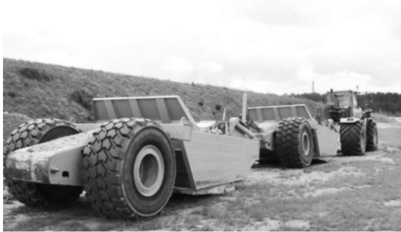
Slika 8.14 Skrejšper vučen traktorom s dva sanduka
