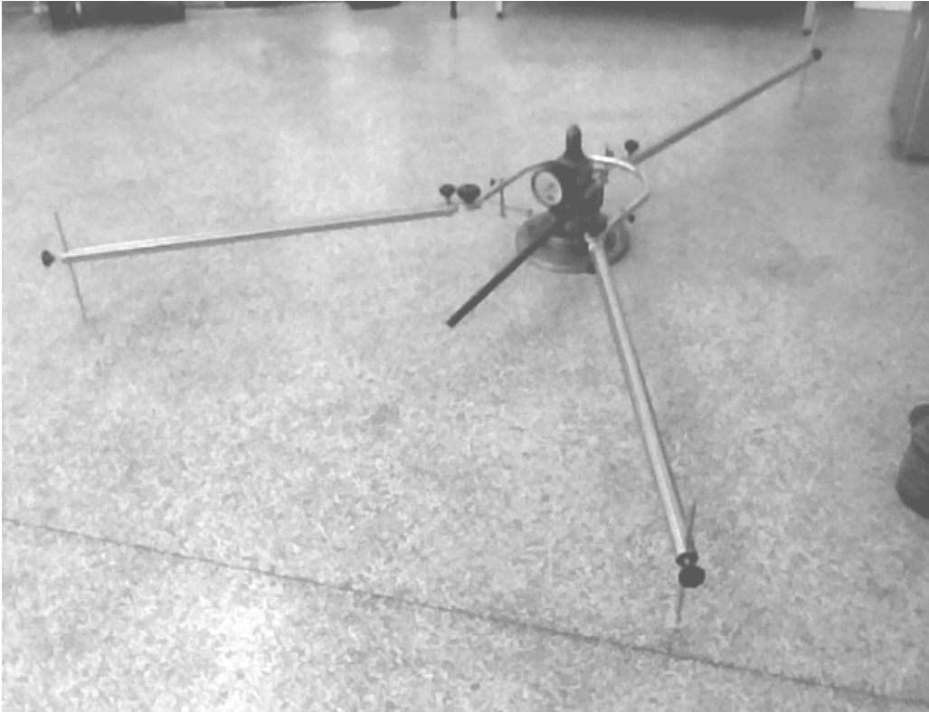
Slika 3.36 Oprema za ispitivanje probnom pločom
