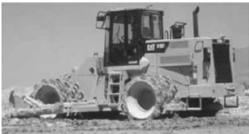
Slika 11.57 Valjak sa širokim stopana
