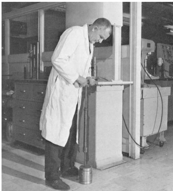
Slika 4.23 Položaj ispitivača i posude pri pokusu Proctorovm iglom (Earth Manual 1974.)
