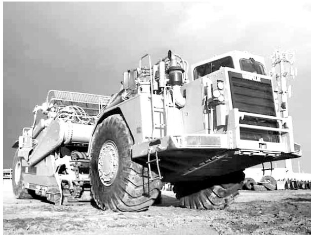
Slika 10.3 Skreper za iskop i prijevoz gradilištem na udaljenosti do 800m.
