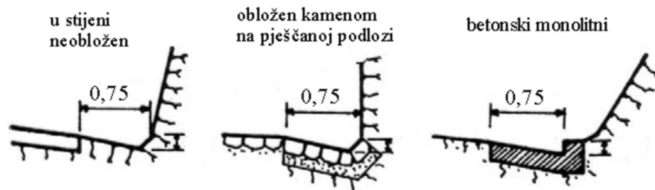
Slika 13.6 Rigoli u nožici pokosa usjeka ili zasjeka
