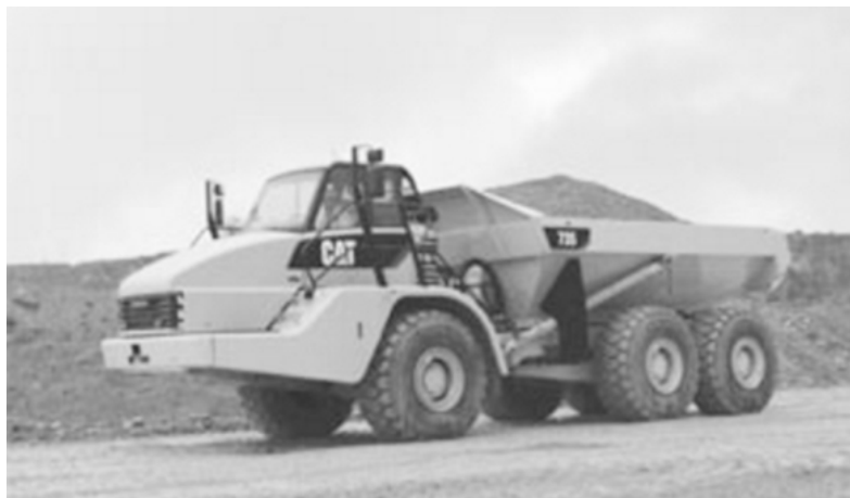
Slika 10.8 Namjensko vozilo za prijevoz i grubo razastiranje
