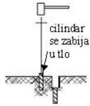
Slika 11.93 Uzimanje uzorka cilindrom iz nasipa
