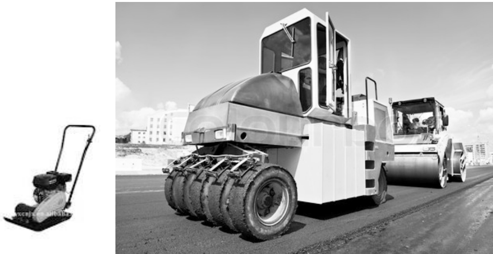
Slika 11.60 Vibroploča, valjak s gumenim kotačima i glatki valjak
