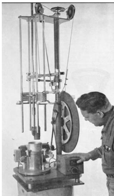
Slika 4.17 Proctorov mehanički nabijač (Earth Manual, 1998.)
