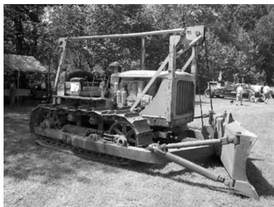
Slika 8.11 Angle dozer na gusjenicama
