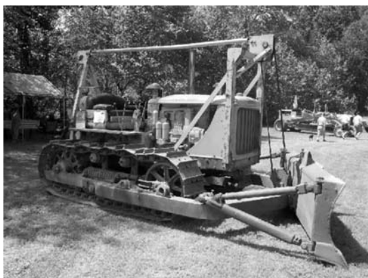
Slika 8.11 Angle dozer na gusjenicama
