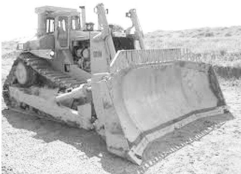
Slika 8.5 Buldozer sa zakrivljenim nožem
