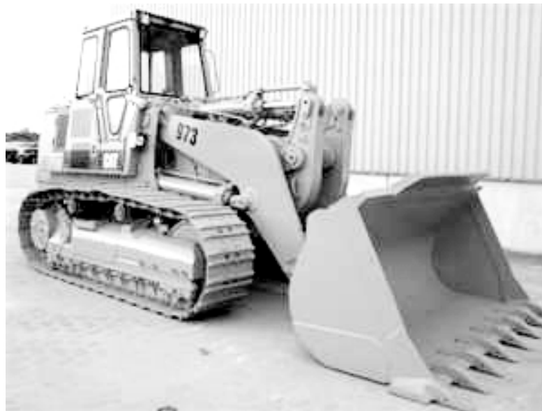
Slika 8.19 Utovarivač na gusjenicama
