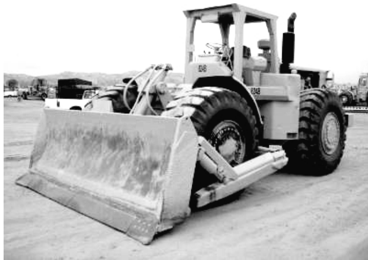
Slika 8.7 Dozer na kotačima
