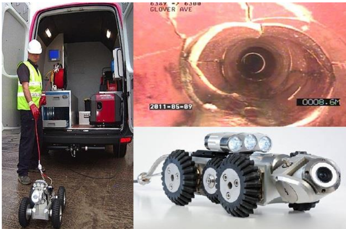
Slika 6. Oprema za unutrašnji pregled pomoću samohodne CCTV kamere [8]
