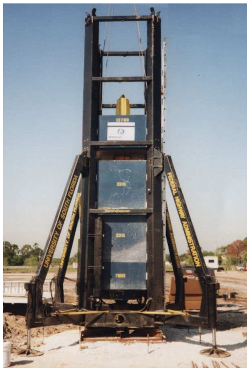
Slika 5.41 Fotografija uređaja s hidrauličkim hvatačem, spremnog za pokus
