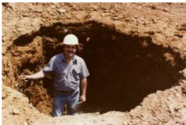
Slika 9.24 Veličina rupe koja nastaje pri udaru tereta o tlo
