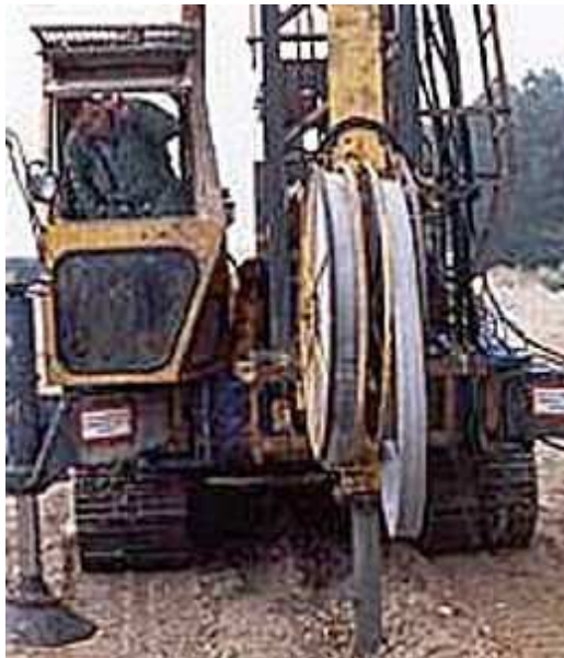
Slika 9.58 Uređaj za ugradnju savitljivih (mekih) drenova
