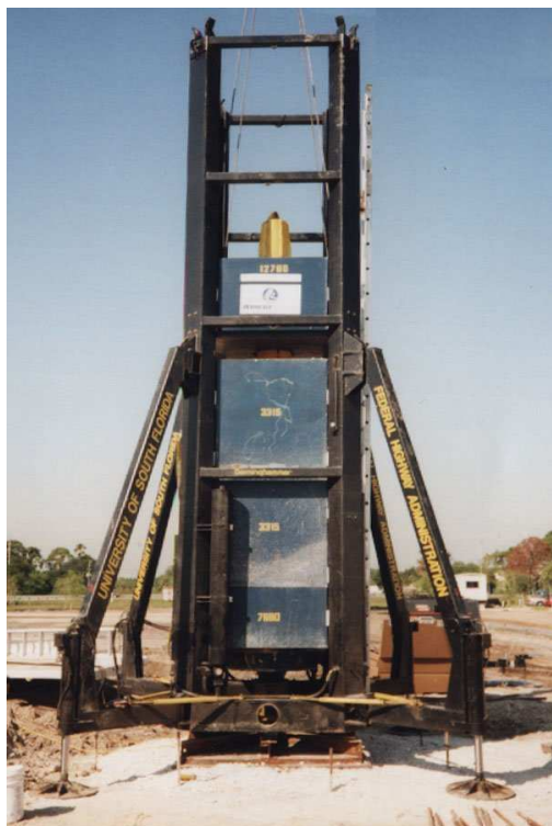
Slika 5.41 Fotografija uređaja s hidrauličkim hvatačem, spremanog za pokus
