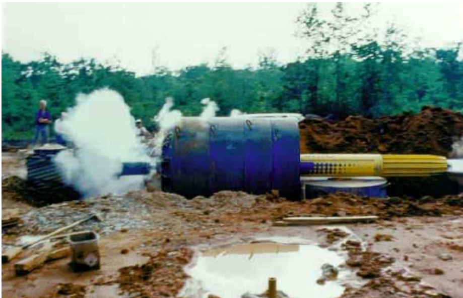
Slika 5.47 Pokus vodoravnog opterećenja u trenutku aktiviranja eksploziva. Vidi se odbojnik na slobodnom kraju kontra tereta
