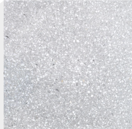
Terazzo - polirani beton sa bijelim agregatom, Interijer crkve
