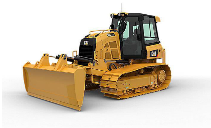
Slika 10.1.: Dozer CAT D3K2 [18]
