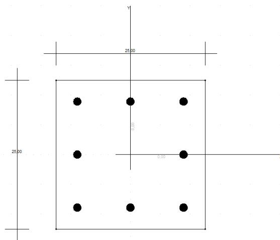
Slika 12.31. Poprečni presjek stupu
