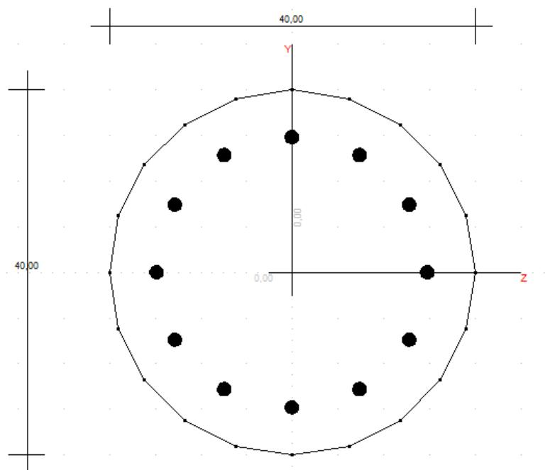
Slika 12.5. Poprečni presjek stupa
