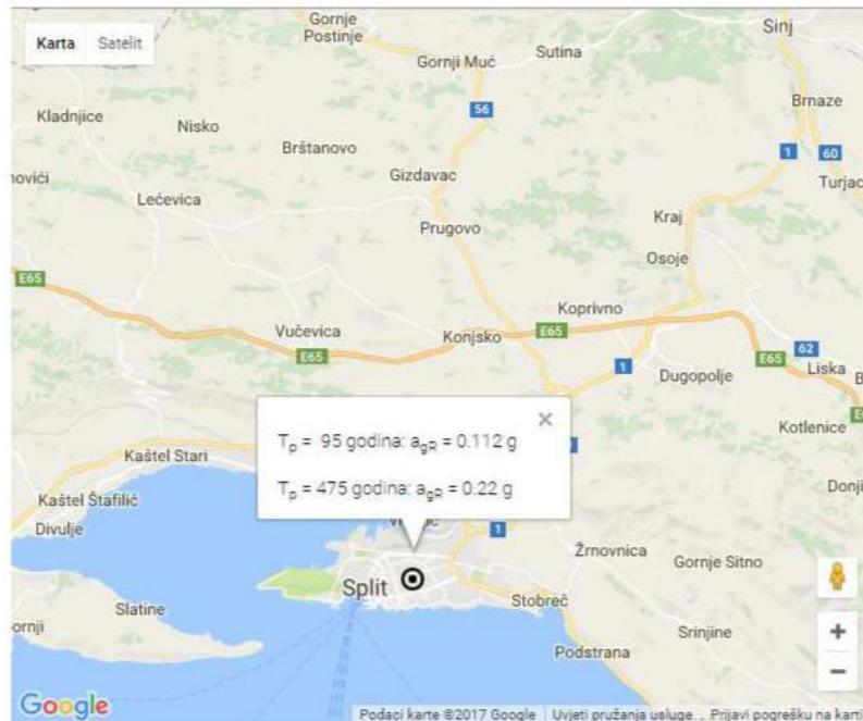
Slika 8.36. Očitano ubrzanje za područje grada Splita
