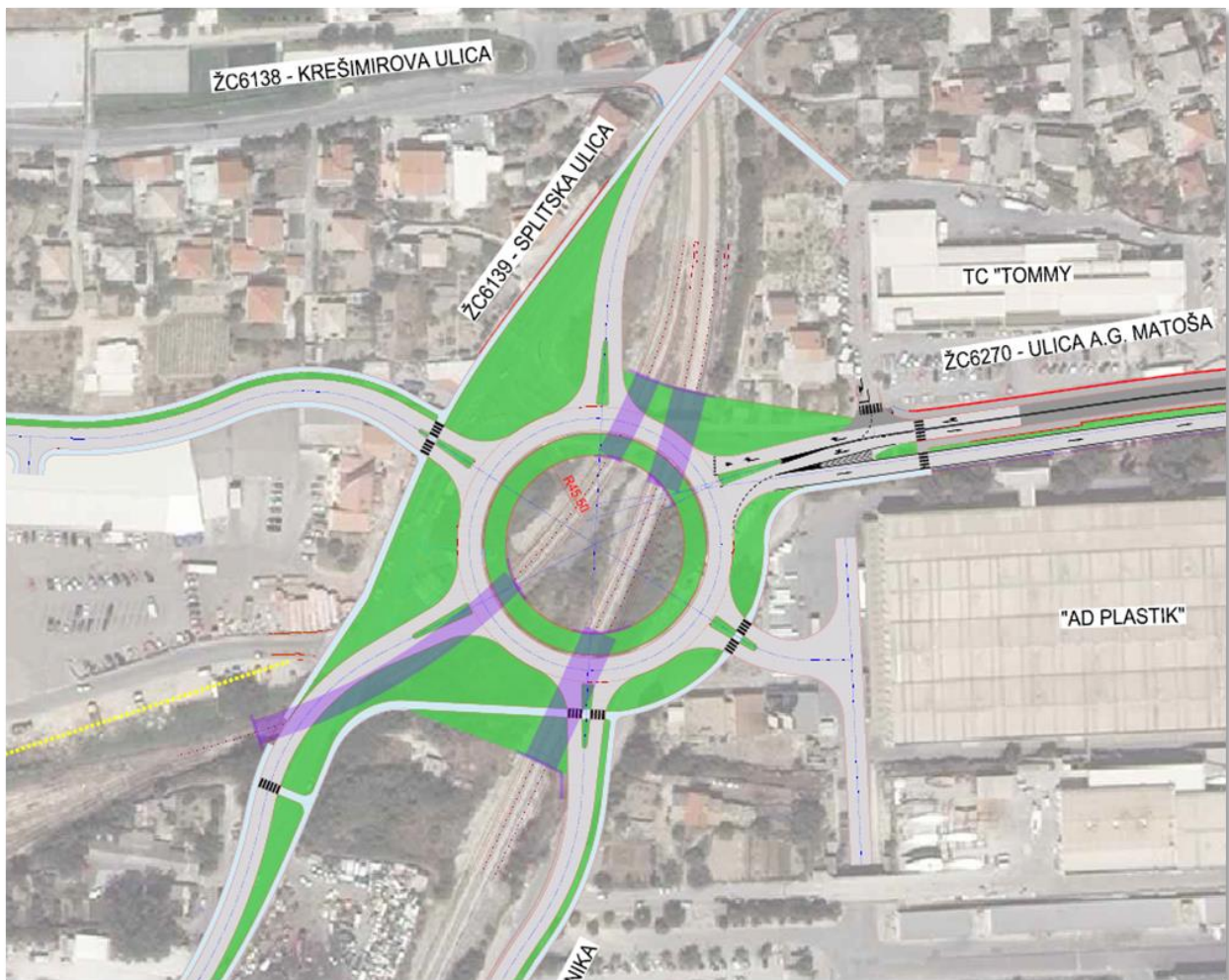
Slika 1.1. Planirani izgled rotora i pozicije mostova
