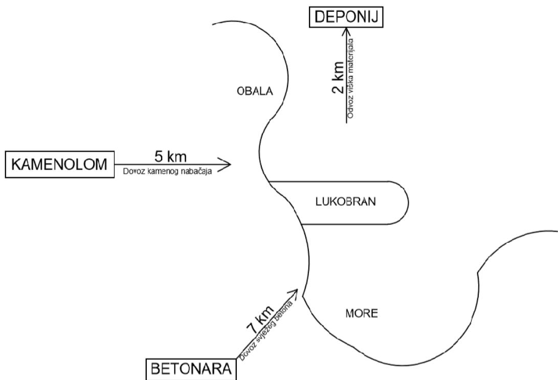
Slika 2.2. Shematski prikaz gradilišta i udaljenosti
