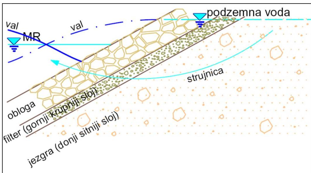
Slika 2.1. Strujanje mora unutar nasutog lukobrana
