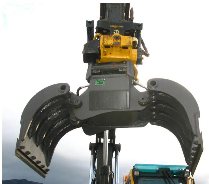
Slika 4.7. Hidraulički grajfer model BG13
