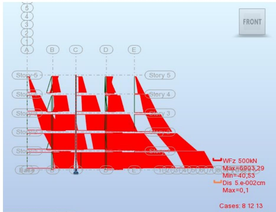
Slika 5.2. Poprečna sila u karakterističnom zidu
