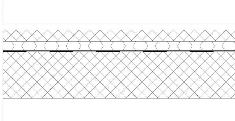
Slika 2.4. Presjek međukatne ploče – prikaz slojeva
