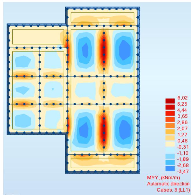
3.26. Momenti savijanja od promjenjivog opterećenja unutra u smjeru Y
