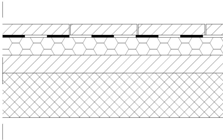
Slika 2.1. Presjek krovne ploče – prikaz slojeva
