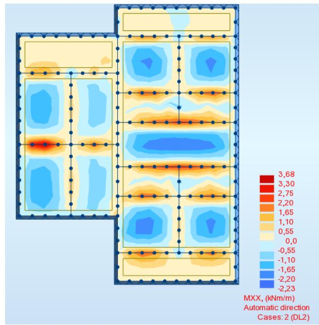
3.10. Momenti savijanja od dodatnog stalnog opterećenja unutra u smjeru X
