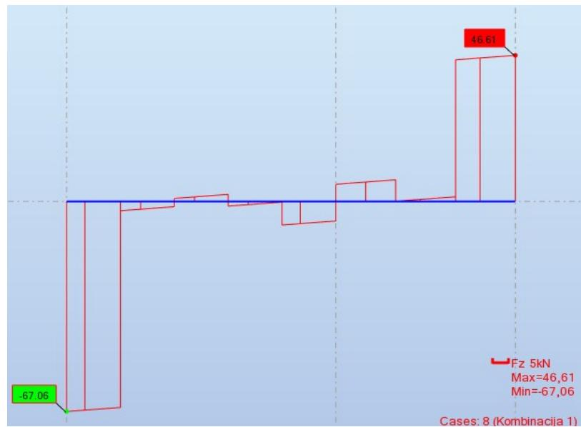
Slika 4.4. Poprečna sila grede POZ 102
