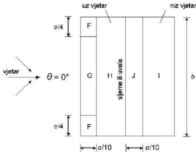
Koeficijenti vanjskog pritiska na halu s krovom nagiba  $\alpha = 5,92^\circ \approx 5^\circ$  za područja dvostrešnog krova  $\Theta=0^\circ$ :
