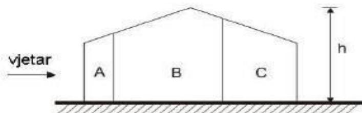
$d < e \rightarrow d < e$  Koeficijenti vanjskog pritiska na halu za vertikalne zidove  $h/d=0,58$
