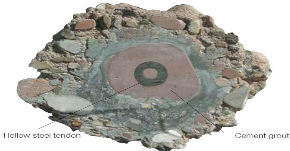
Slika 12. Presjek samobušivog injektiranog sidra
