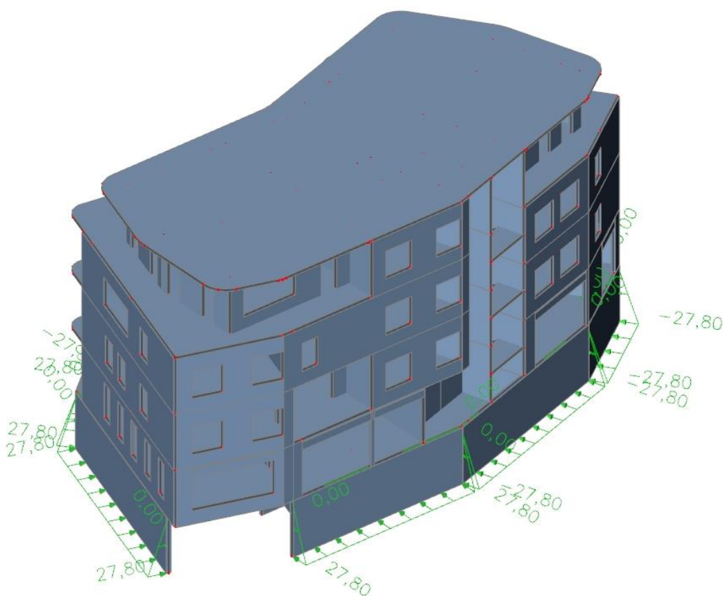
Slika 3.2. Prikaz opterećenja od tla na zidove garaže
