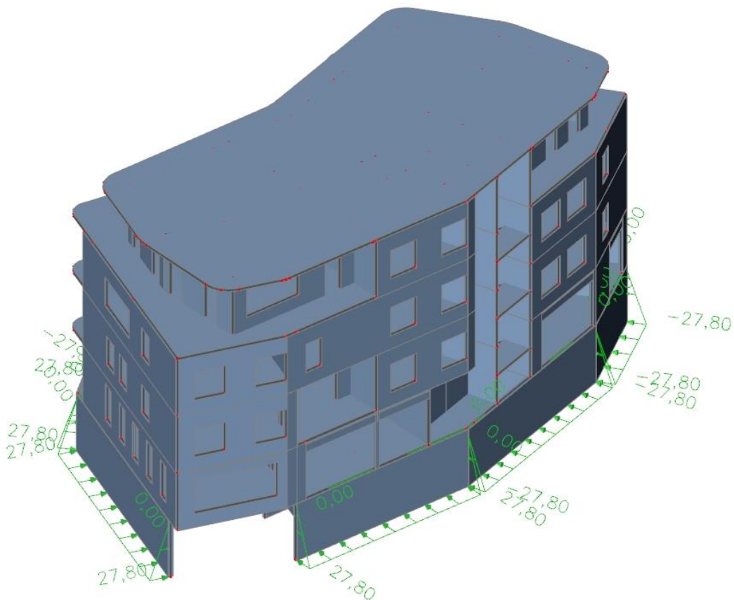
Slika 3.2. Prikaz opterećenja od tla na zidove garaže
