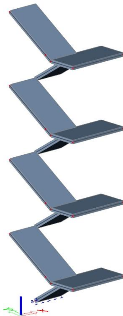
Slika 6.1. Prikaz statičkog sustava kraka stubišta
