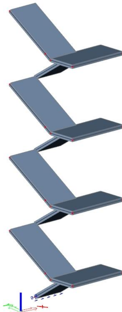
Slika 6.1. Prikaz statičkog sustava kraka stubišta
