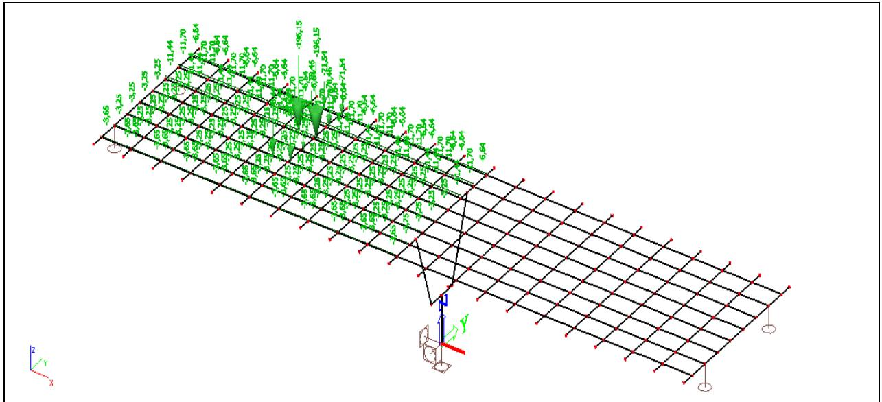
Slika 21: Pokretno opterećenje za ma. moment pri stupu
