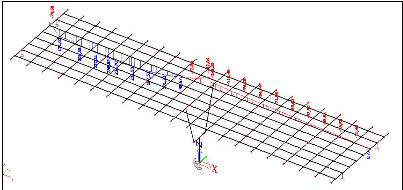
Slika 31: Pokretno - max. poprečne sile pri upornjaku - momenti (  $M_y$  ) u kNm
