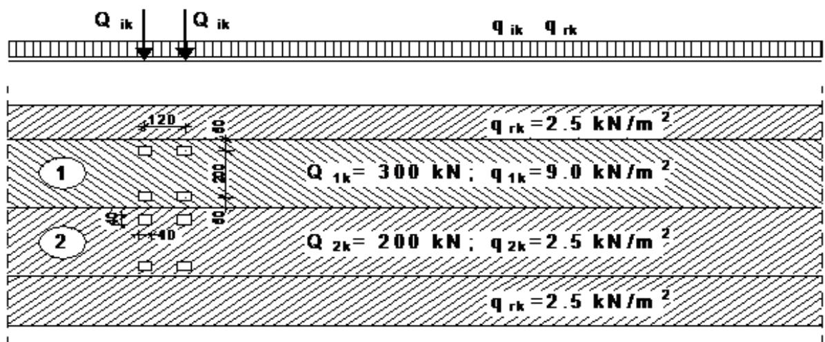
Slika 16 : Prikaz načina opterećivanja mosta pokretnim opterećenjem
