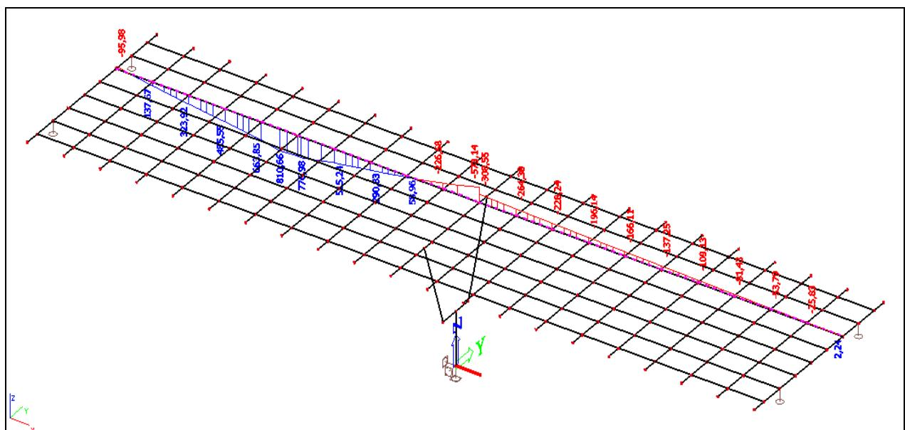
Slika 23: Pokretno - max. momenti pri stupu - momenti ( $M_y$ ) u kNm
