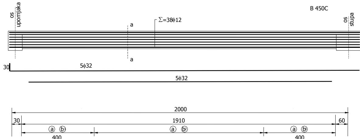
Slika 35 : Prikaz armiranja uzdužnog nosača u polju
