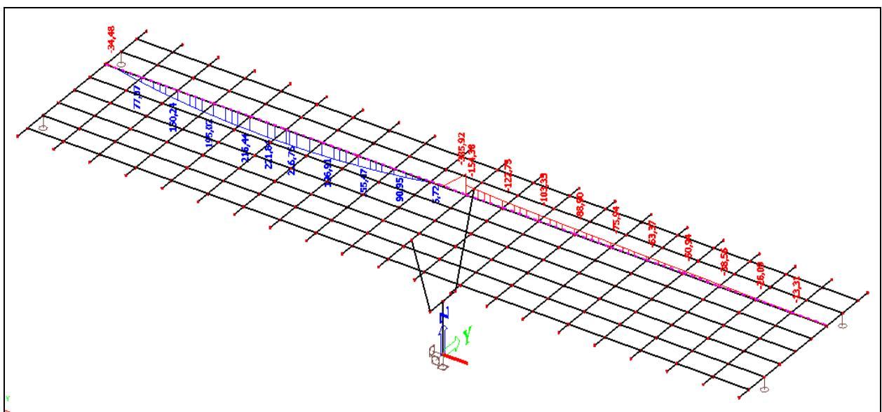
Slika 27: Pokretno - max. poprečne sile pri stupu - momenti ( $M_y$ ) u kNm
