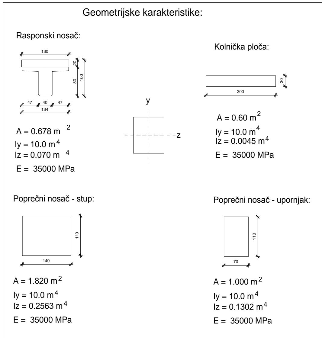
Slika 9: Karakteristike poprečnih presjeka gornjeg ustroja mosta
