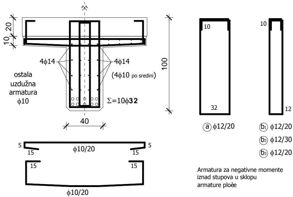
Slika 36 : Prikaz armiranja nosača u presjeku a-a
