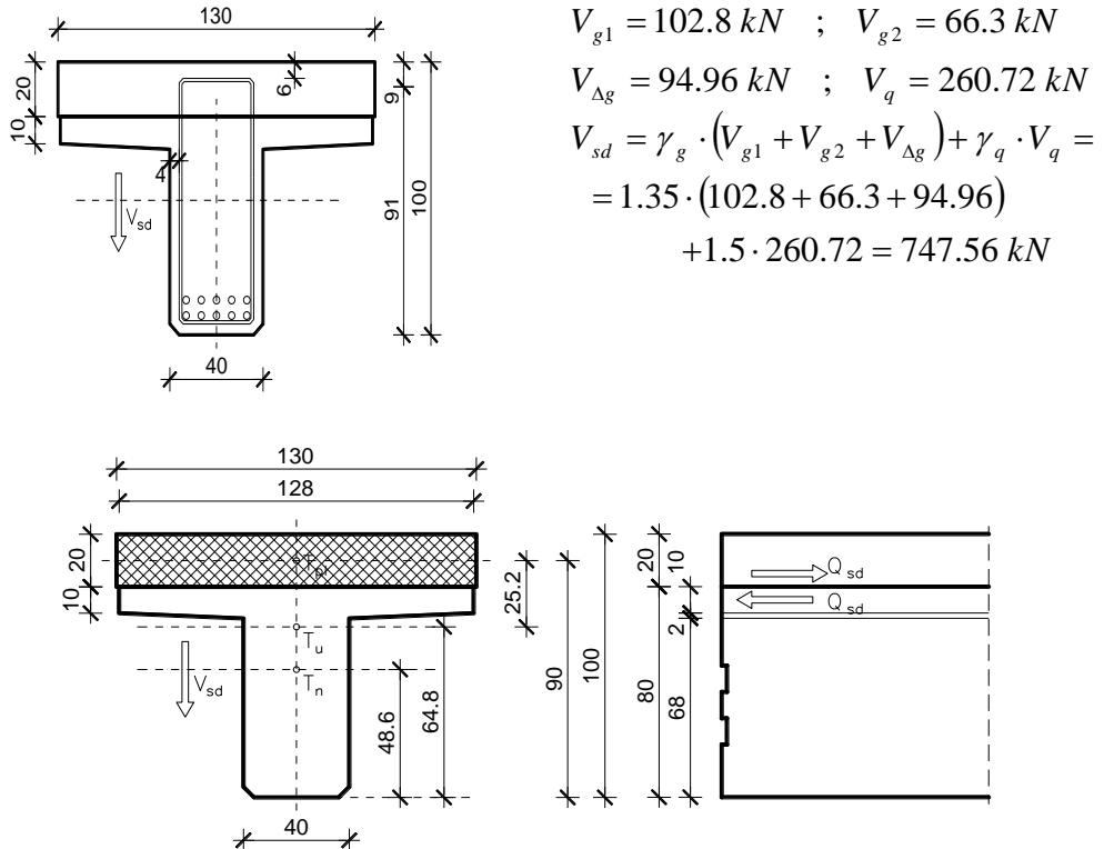
Slika 34 : Poprečni presjek spregnutog T nosača
