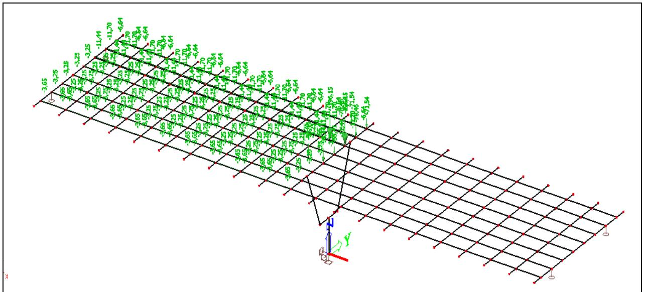
Slika 25: Pokretno opterećenje za max. porpečnu sliu pri stupu
