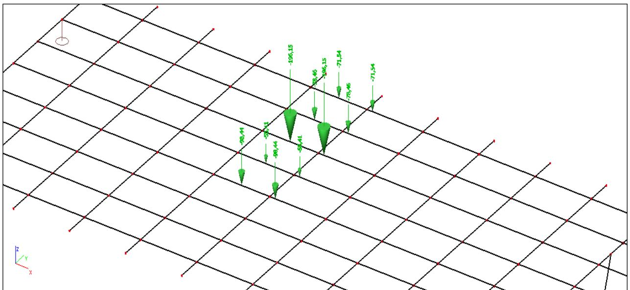
Slika 22: Prikaz tipskog opterećenja vozila za max. moment pri stupu
