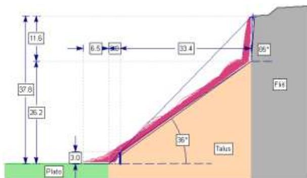
(e) Trajektorije blokova sa barijerom h=3 m.
