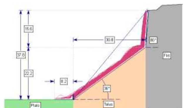
(d) Trajektorije blokova sa barijerom h=2 m.
