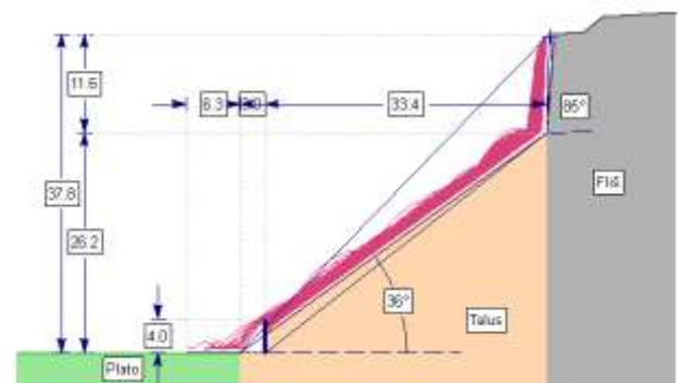
(f) Trajektorije blokova sa barijerom h=4 m.
