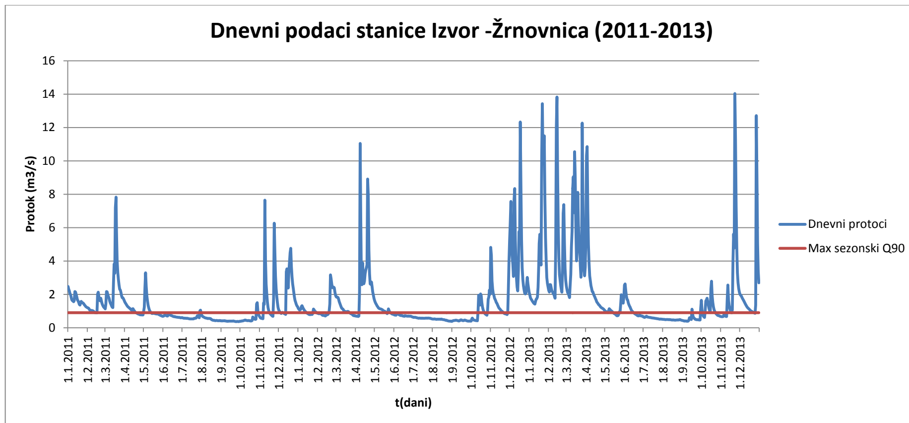
Slika 5.32. Hidrogram sa usvojenim maksimalnim sezonskim (1.svibnja-1.listopada) pragom transformacije za cijelo promatrano razdoblje: Q_{90}=0,90 \text{ m}^3/\text{s}
