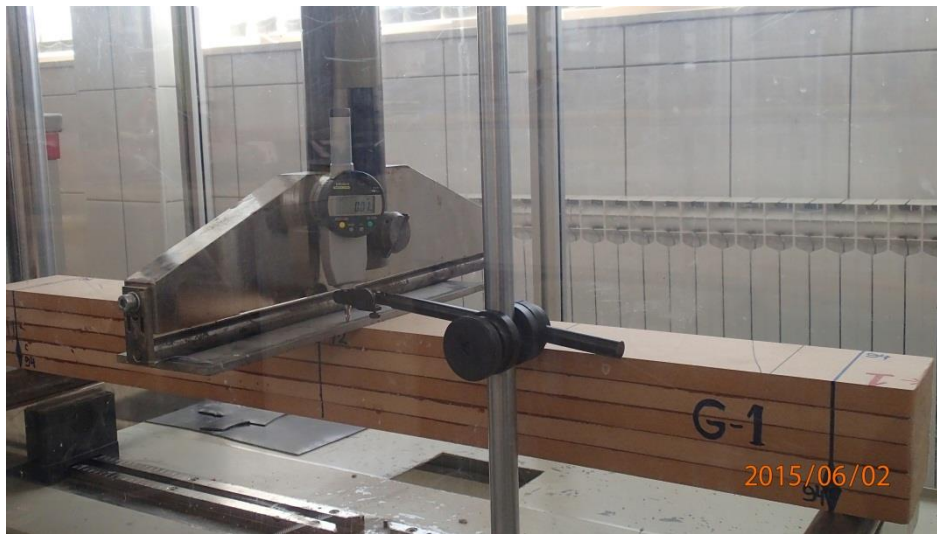
Fotografija 4.12: Početak opterećenja grede G-1
