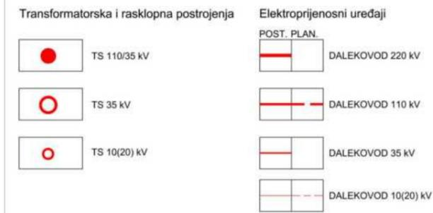
Kao što je vidljivo na prikazu energetskih sustava preko planiranog obuhvata prelaze 3 dalekovoda. U takvim slučajevima se treba paziti da se gradi prema posebnim pravili i pridržava se odgovarajućih distanci od dalekovoda zbog sigurnosnih razloga. Za svaki dalekovod potrebno da je napraviti odgovarajući razmak od središnje osi njegovog pravca.
