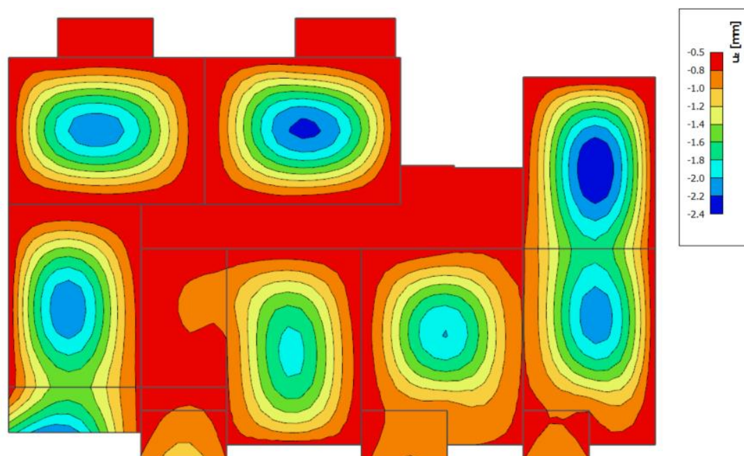
Slika 4.11. Progib ploče (mm) za kombinaciju GSU2
