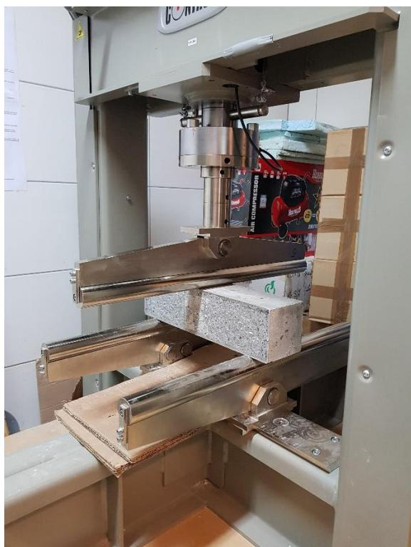
Slika 5.16. Ispitivanje čvrstoće na savijanje
