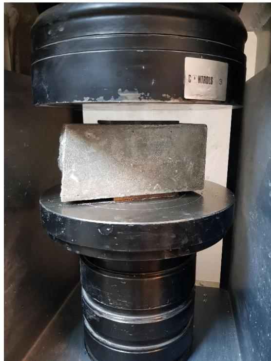
Slika 5.14. Ispitivanje tlačne čvrstoće nad polovicama prizme
