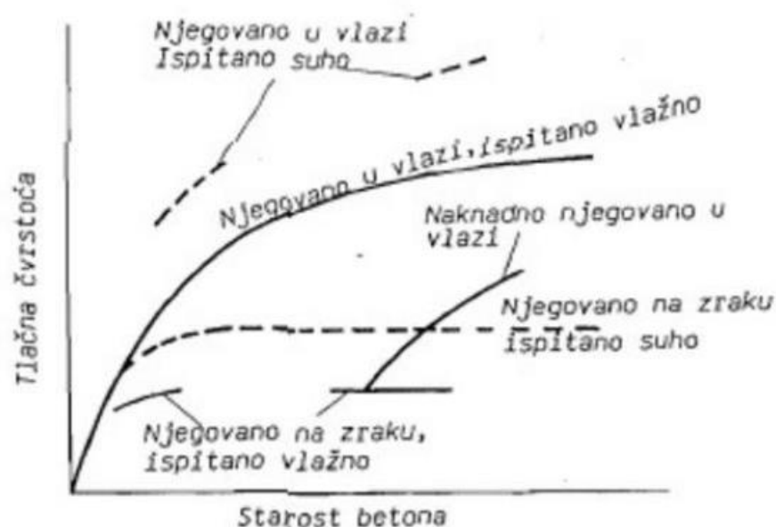
Slika 2.5. Utjecaj vlažnosti uzorka na tlačnu čvrstoću [5]
