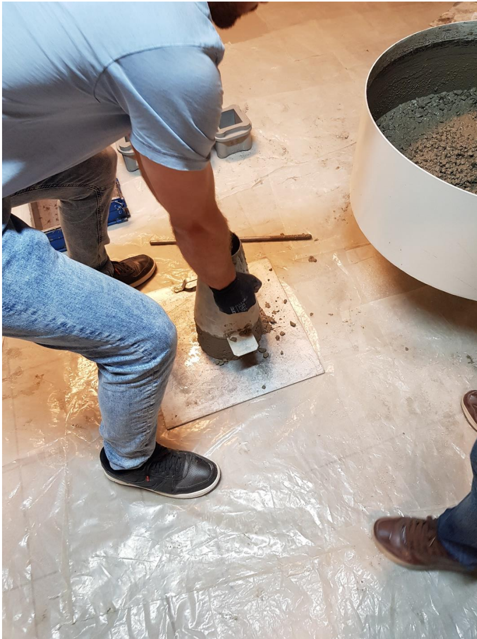
Slika 5.13. Ispitivanje konzistencije metodom slijeganja
