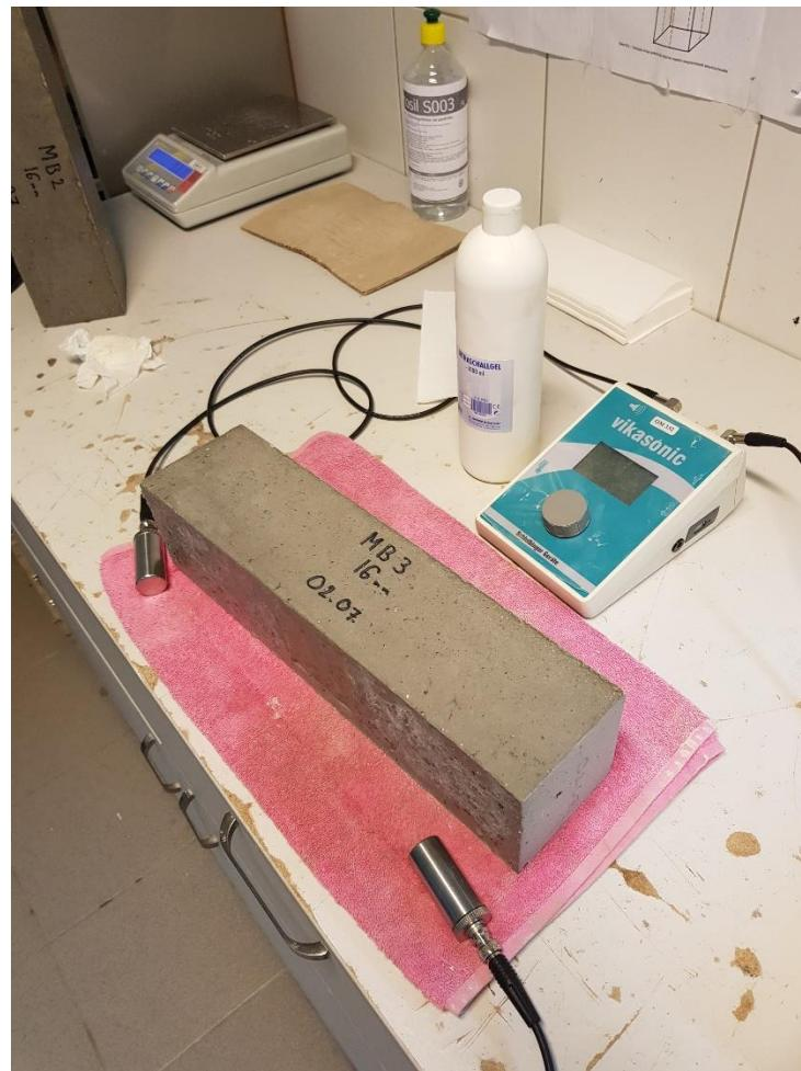
Slika 5.18. Uređaj za mjerjenje brzine prolaska UZV kroz uzorak
