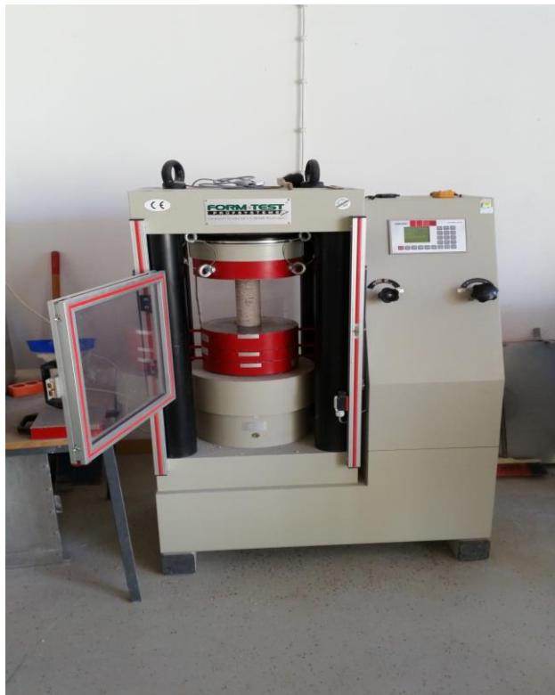
Slika 2.2. Hidraulička preša
