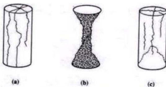
Slika 4.11. Oblici testiranih uzoraka valjka [12]
