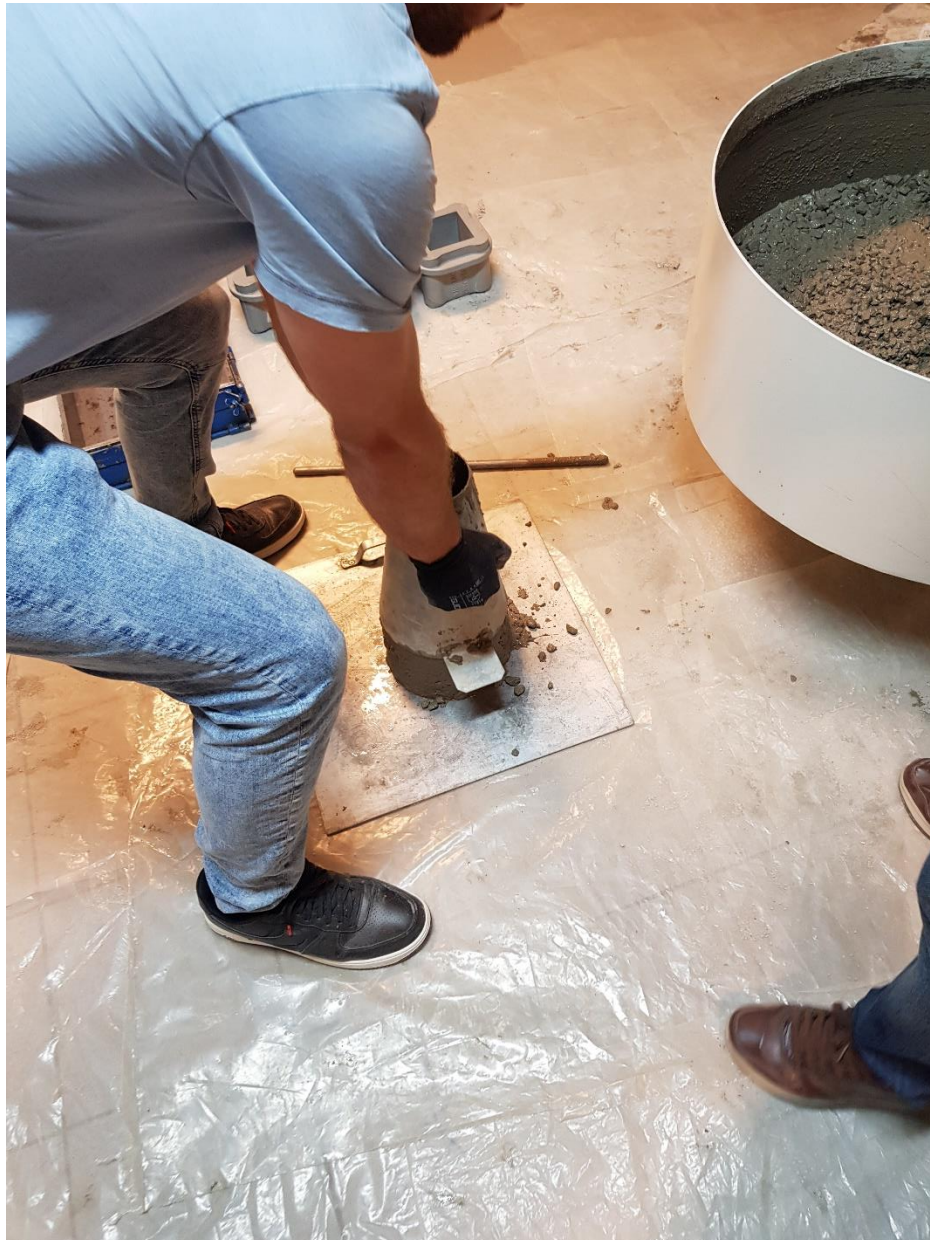
Slika 5.13. Ispitivanje konzistencije metodom slijeganja
