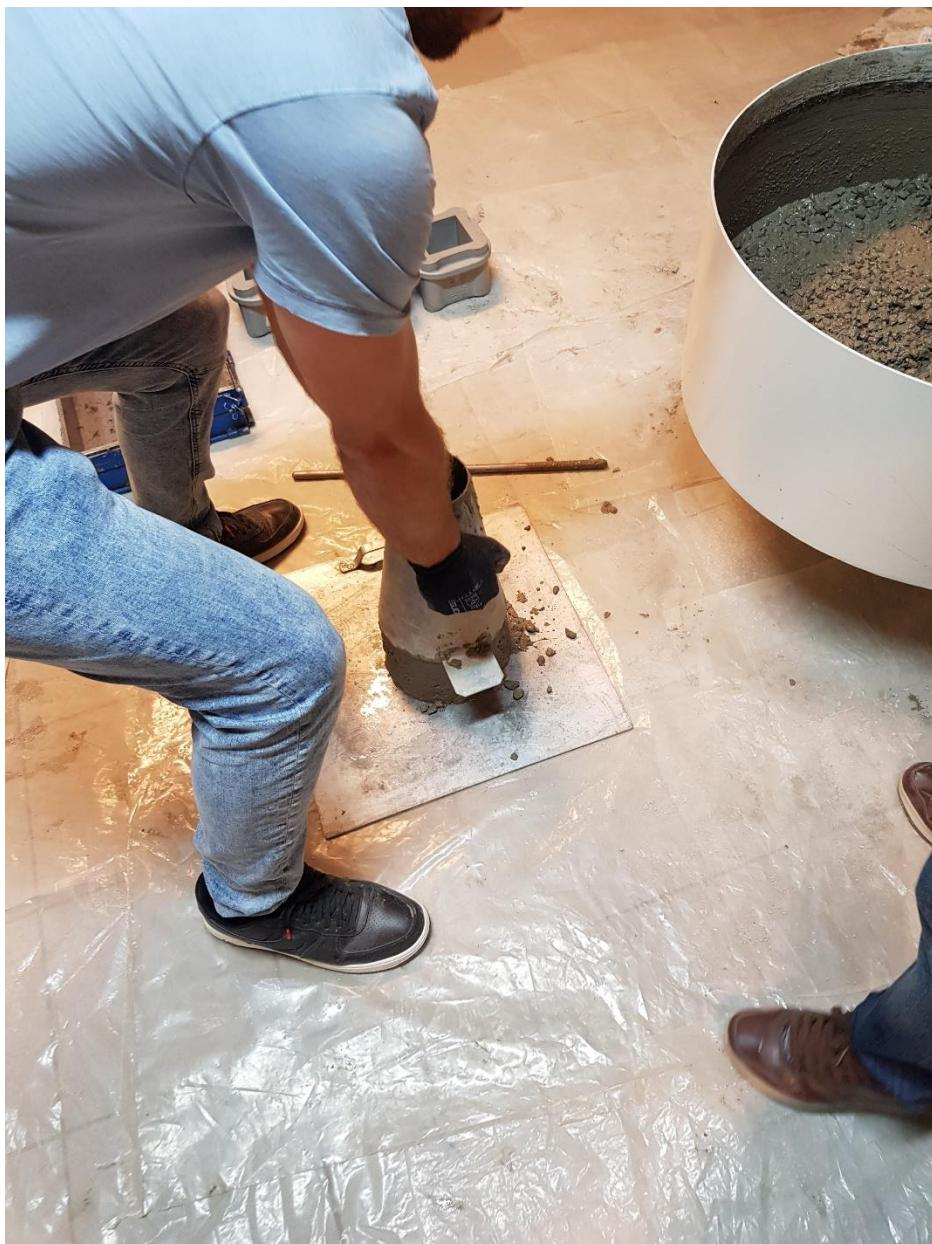
Slika 5.13. Ispitivanje konzistencije metodom slijeganja
