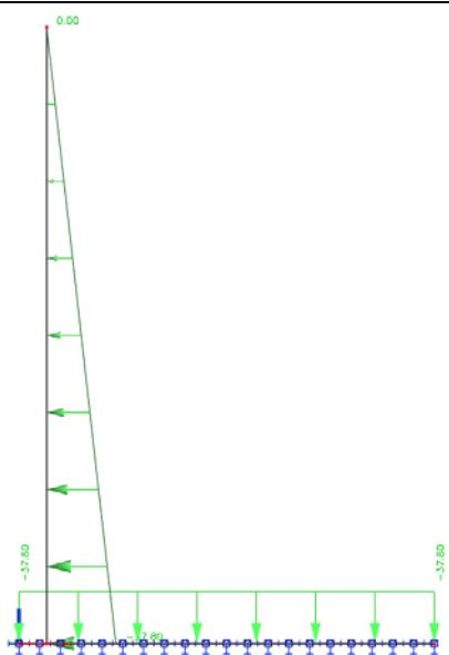
Slika 136 Prikaz stalnog opterećenja na potporni zid
