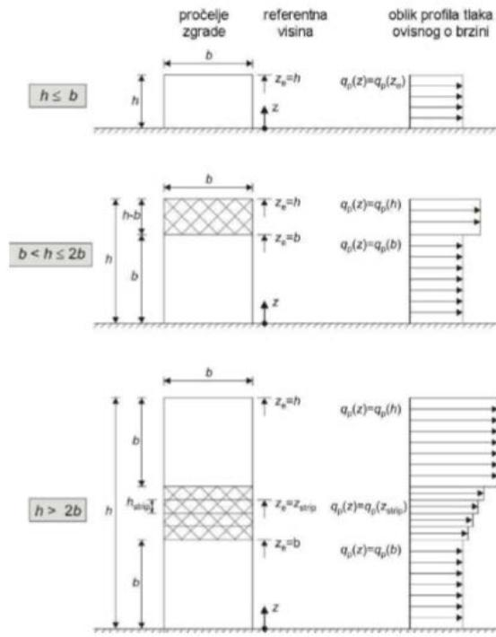
Slika 18 Referentna visina,  $z_e$ , ovisna o  $h$  i  $b$  $h \approx 12m$  $b = 16.94m$
