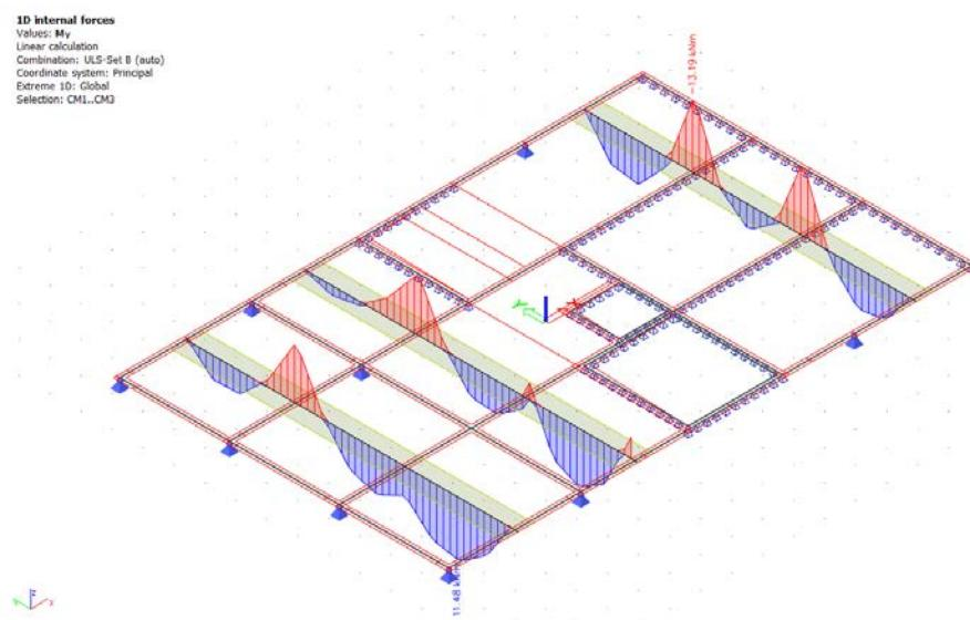
Slika 57 1D dijagram savijanja Mx (kraći smjer)
