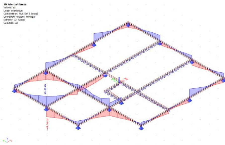
Slika 53 Dijagram poprečnih sila  $V_z$  na gredama
