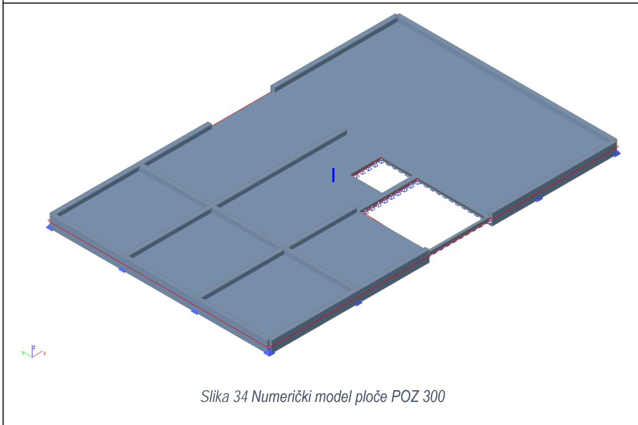
Slika 34 Numerički model ploče POZ 300
