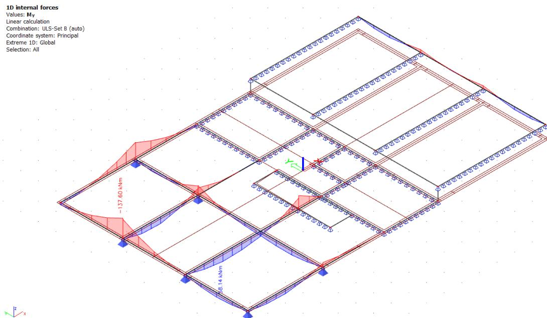
Slika 78 Dijagram momenata savijanja  $M_y$  na gredama
