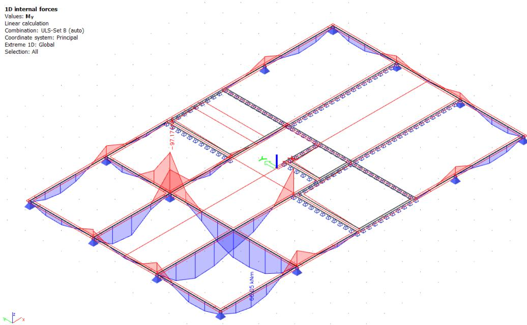
Slika 70 Dijagram momenata savijanja na gredama  $M_y$
