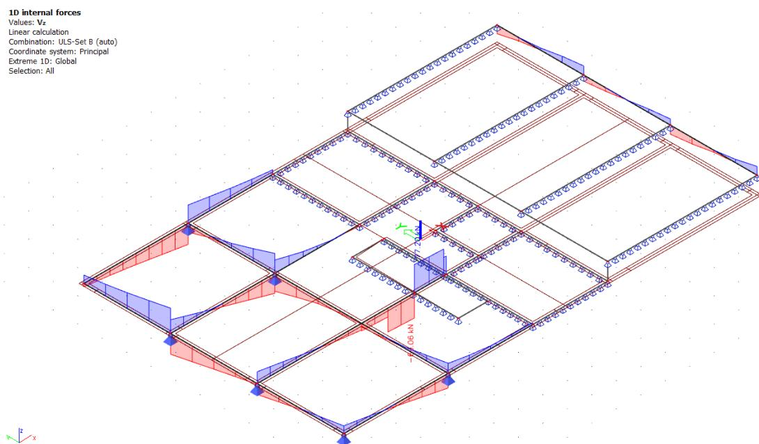
Slika 79 Dijagram poprečnih sila  $V_z$  na gredama
