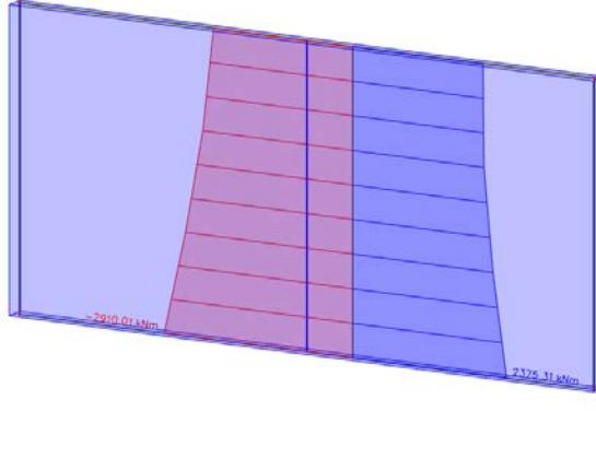
*Slika 111 Maksimalni moment savijanja na promatrani zid***1D internal forces**Values:  $V_z$
