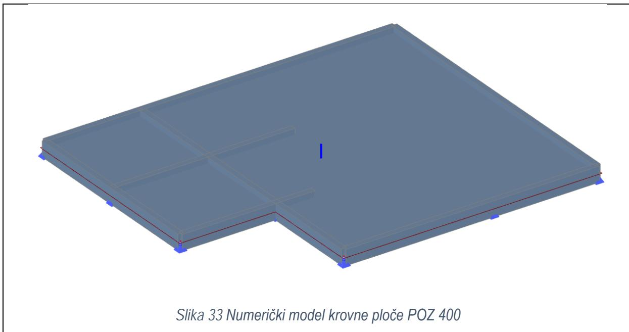
Slika 33 Numerički model krovne ploče POZ 400
