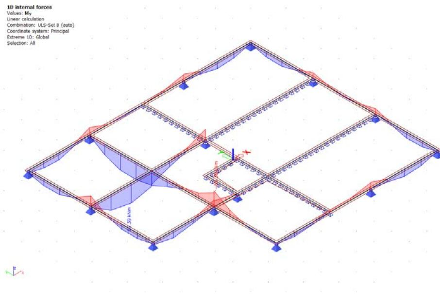
Slika 52 Dijagrami momenata savjianja  $M_y$  na gredama
