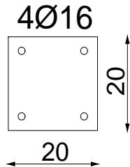
Slika 106 Poprečni presjek stupa pozicije S2
