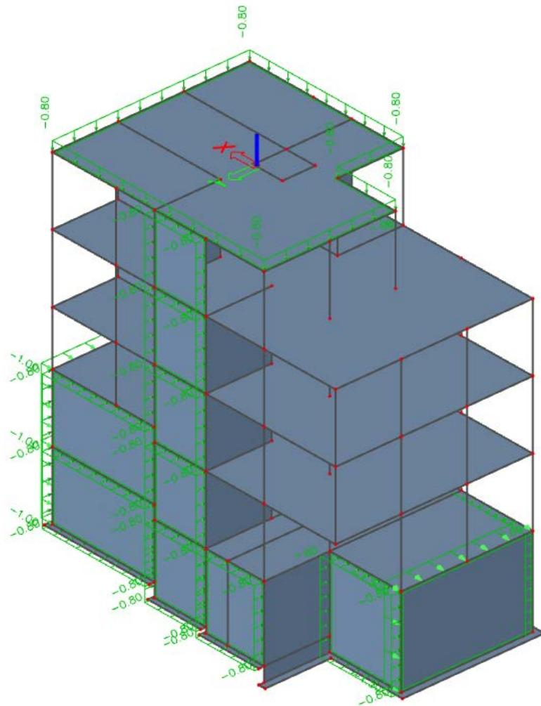
Slika 23 Prikaz opterećenja od vijetra na konstrukciju
