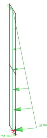
Slika 132 Prikaz stalnog opterećenja na zatrpani zid
