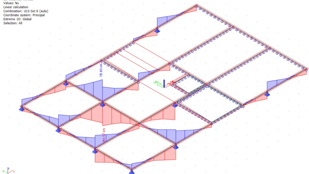
Slika 63 Dijagram poprečnih sila  $V_z$  na gredama
