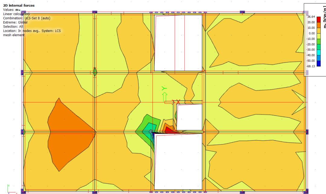
Slika 67 2D dijagram savijanja momenata savijanja  $M_x$
