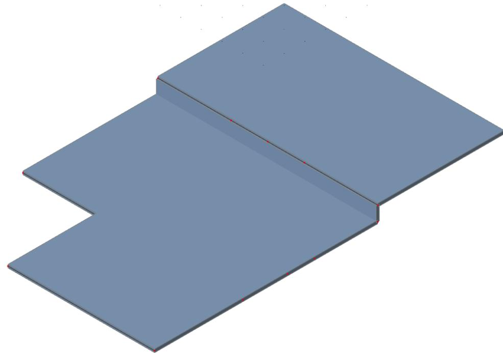
Slika 37 Numerički model podne ploče POZ 000
