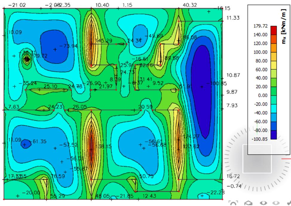
Slika 12.4. Moment savijanja  $M_{Ed,x}$  ( $\text{kNm/m}$ ) za GSU-1
