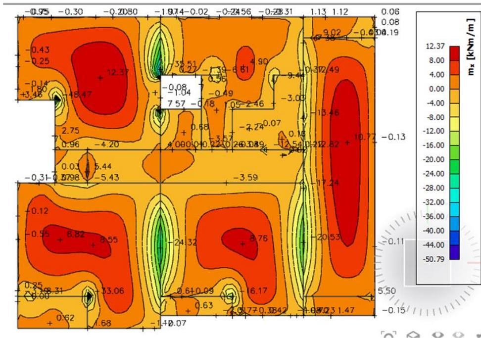
Slika 6.5. Moment savijanja  $M_{Ed,x}$  ( $\text{kNm/m}$ ) za GSU-1
