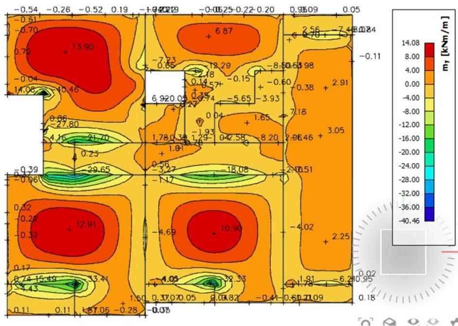
Slika 6.6. Momenti savijanja  $M_{Ed,y}$  ( $\text{kNm/m}$ ) za GSU-1
