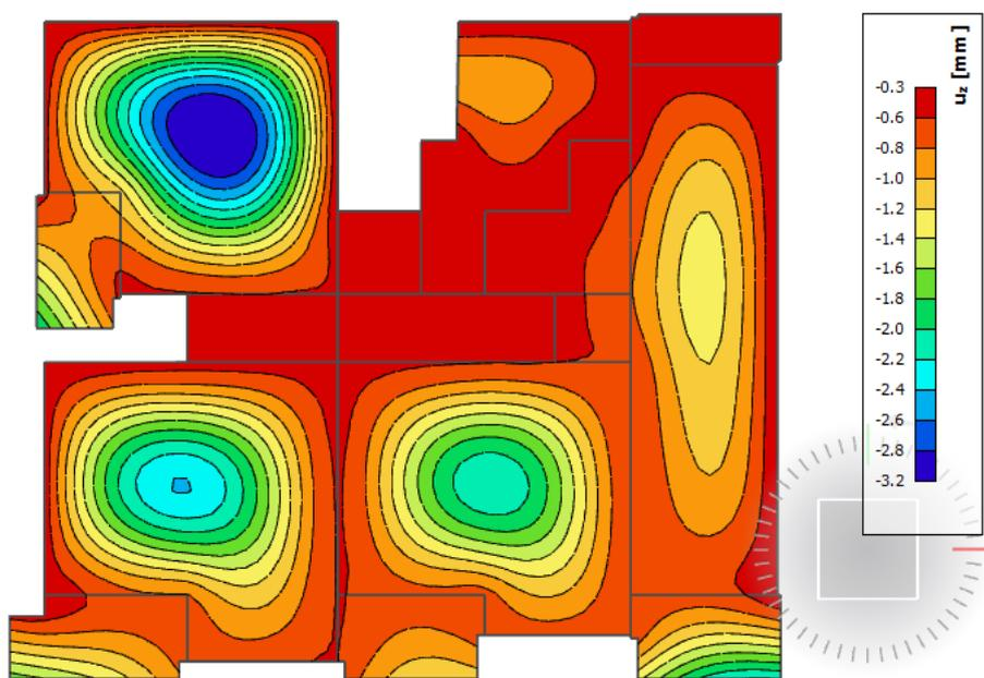
Slika 5.4. Progib ploče (mm) za kombinaciju GSU-2
