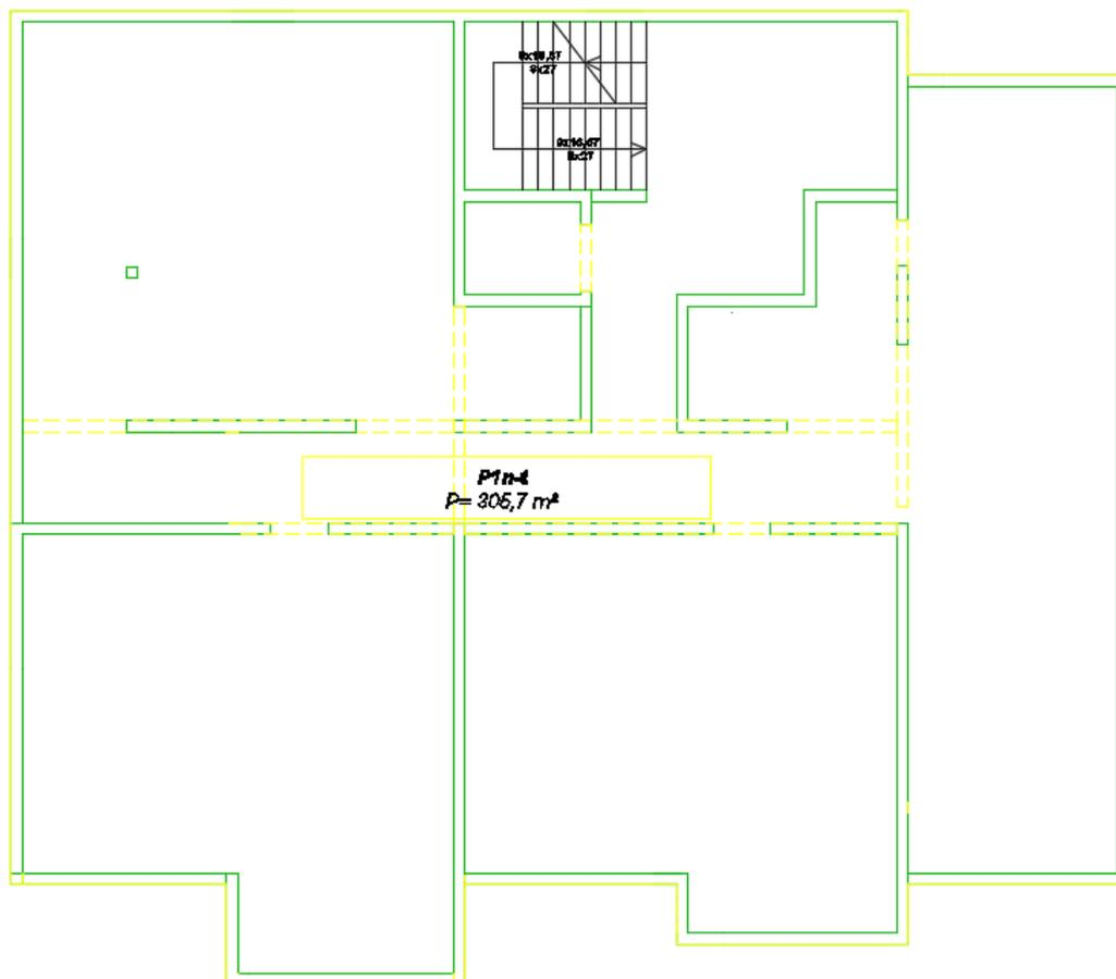
Slika 13.4. Prikaz horizontalnih građevnih dijelova na tlu
