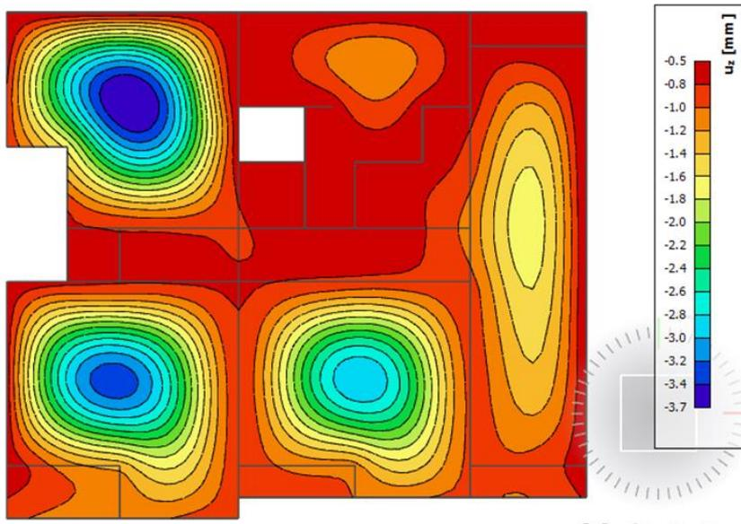
Slika 6.3. Progib ploče (mm) za kombinaciju GSU-1
