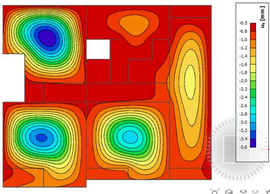
Slika 6.4. Progib ploče (mm) za kombinaciju GSU-2
