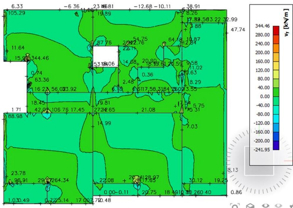
Slika 6.10. Poprečne sile  $V_{sd,y}$  [kNm/m] za GSN-1
