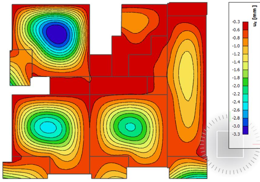
Slika 5.3. Progib ploče (mm) za kombinaciju GSU-1
