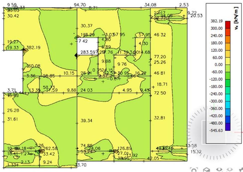
Slika 6.9. Poprečne sile  $V_{sd,x}$  [kNm/m] za GSN-1
