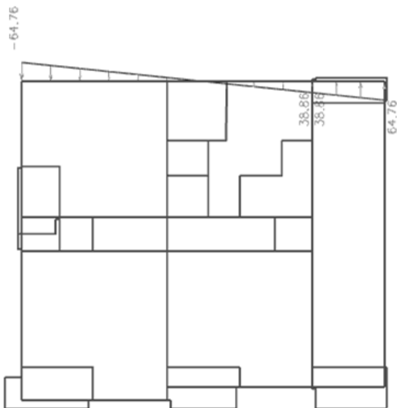
Slika 4.8. Slučajni utjecaj torzije u smjeru y ( T_y )
