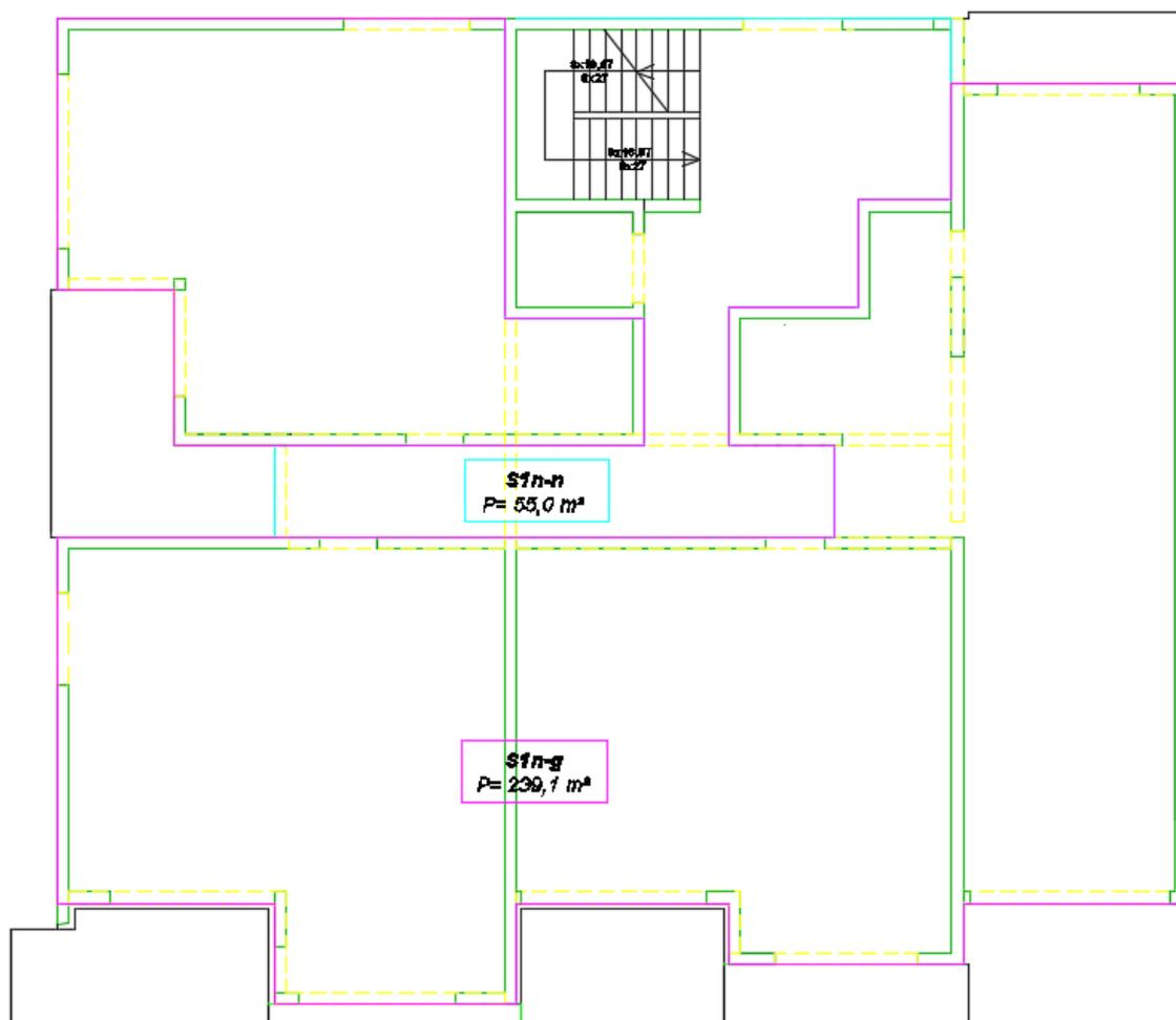
Slika 13.5. Prikaz horizontalnih građevnih dijelova prema negrijanim prostorima
