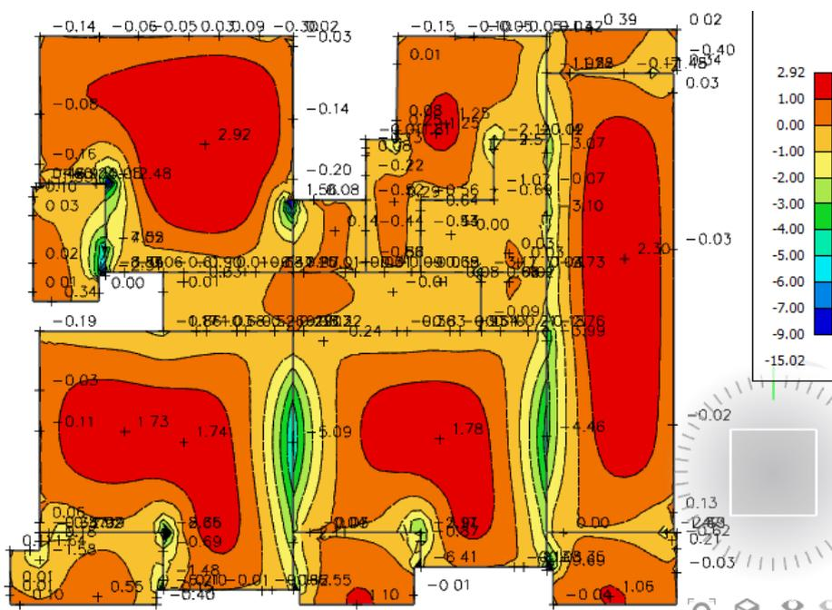
Slika 5.11. Armatura u ploči smjer  $A_{s,x-x}$  (cm<sup>2</sup>/m) za GSN
