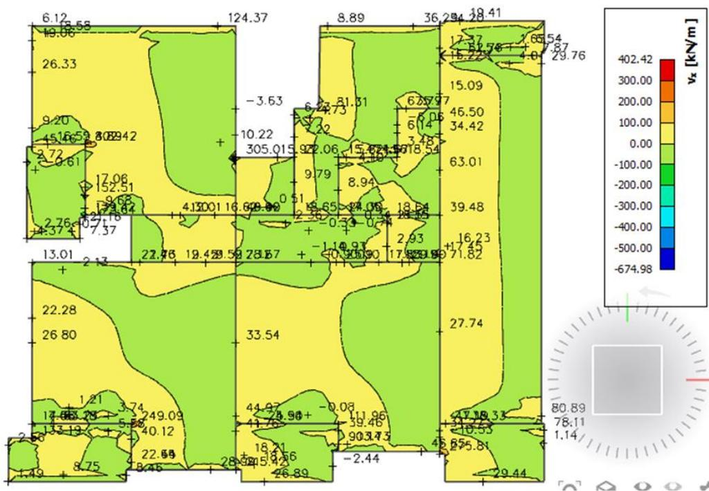
Slika 5.9. Poprečne sile  $V_{sd,x}$  [kNm/m] za GSN-1
