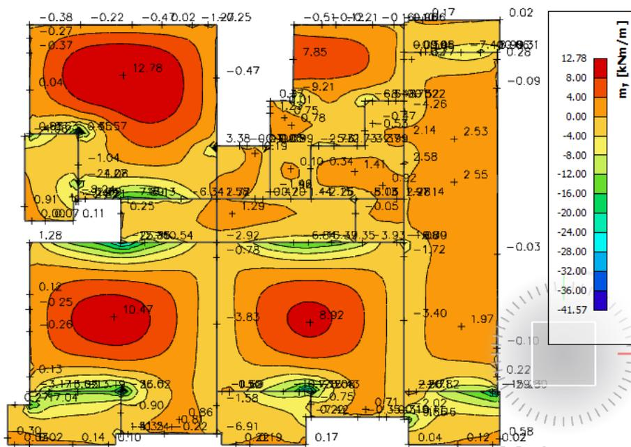
Slika 5.6. Moment savijanja  $M_{Ed,y}$  ( $\text{kNm/m}$ ) za GSU-1
