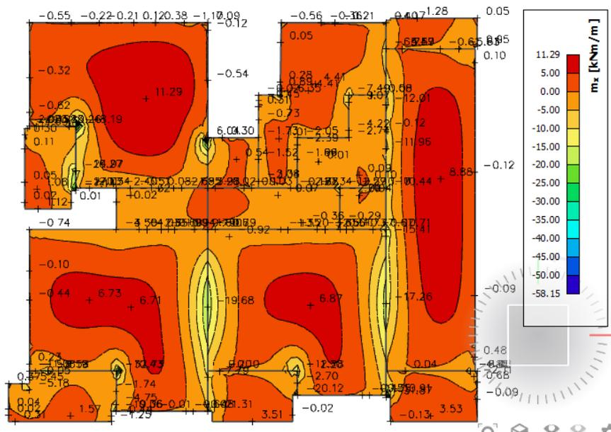
Slika 5.5. Moment savijanja  $M_{Ed,x}$  ( $\text{kNm/m}$ ) za GSU-1
