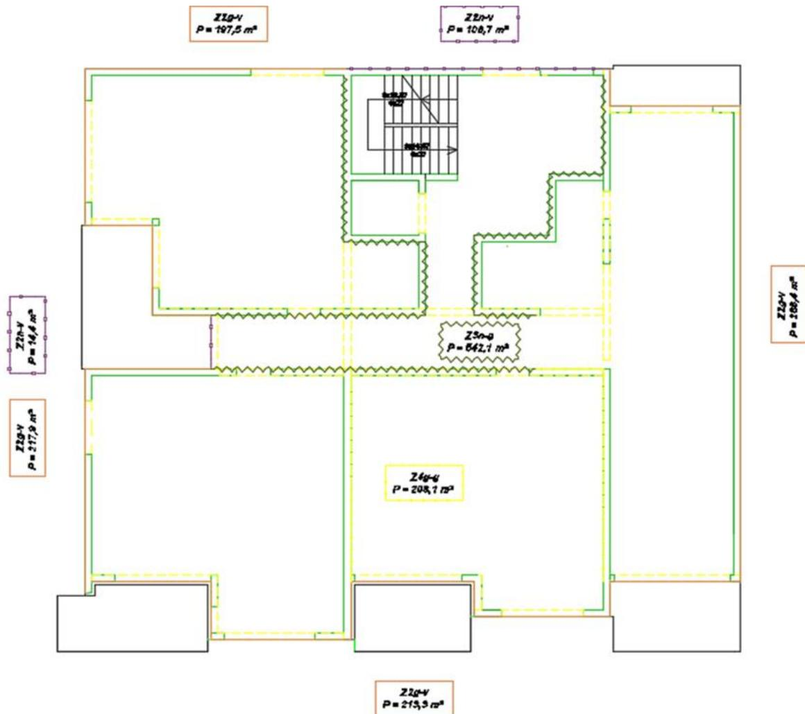
Slika 13.1. Prikaz vertikalnih građevnih dijelova na karakterističnoj etaži
