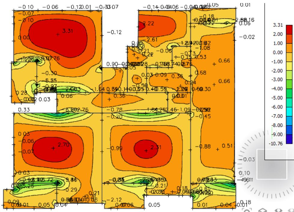
Slika 5.12. Armatura u ploči smjer  $A_{s,y-y}$  ( $\text{cm}^2/\text{m}$ ) za GSN
