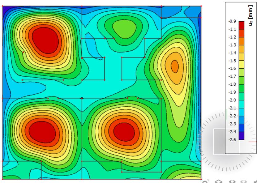
Slika 12.1. Progib ploče (mm) za kombinaciju GSU-1
