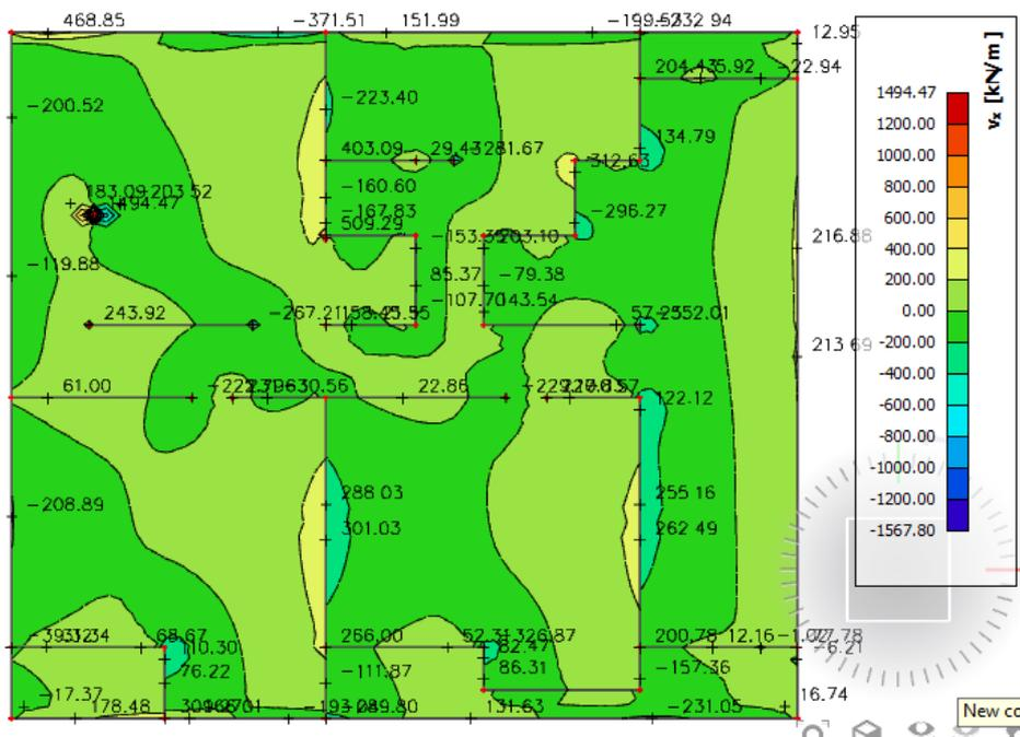
Slika 12.8. Poprečne sile  $V_{sd,x}$  [kNm/m] za GSN-1
