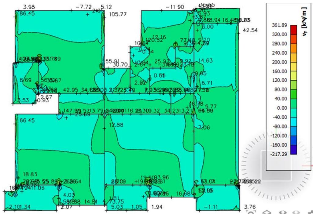
Slika 5.10. Poprečne sile  $V_{sd,y}$  [kNm/m] za GSN-1
