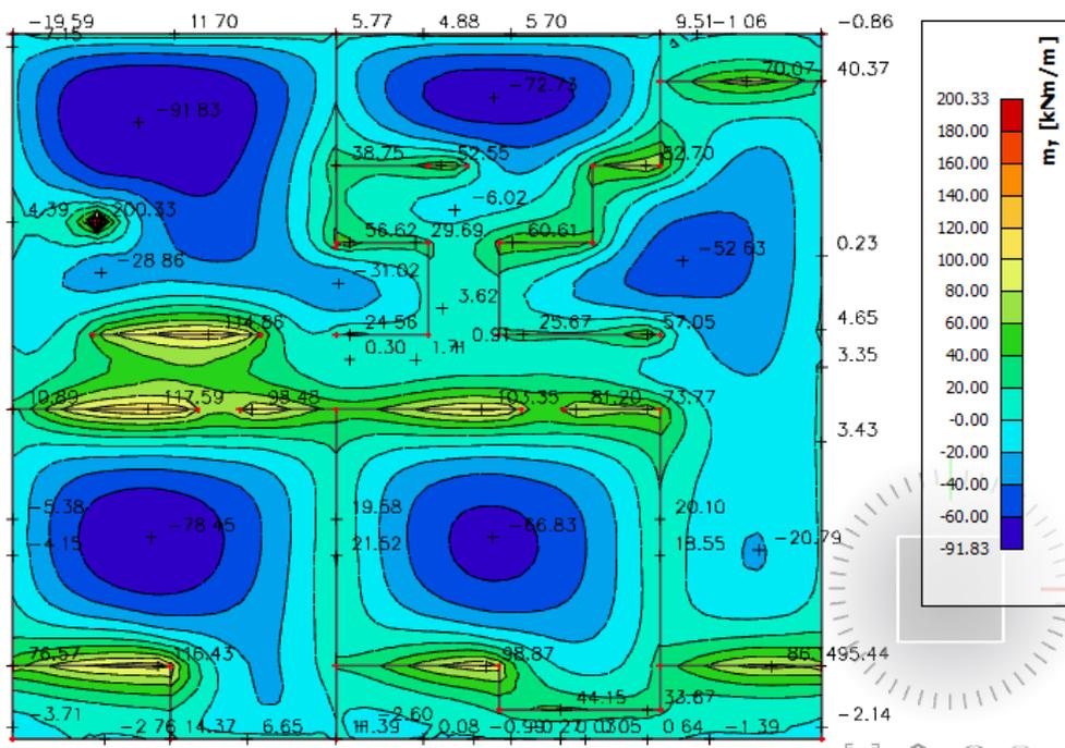
Slika 12.5. Momenti savijanja  $M_{Ed,y}$  ( $\text{kNm/m}$ ) za GSU-1
