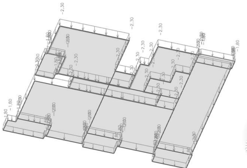
Slika 5.1. Dodatno stalno opterećenje karakteristične ploče
