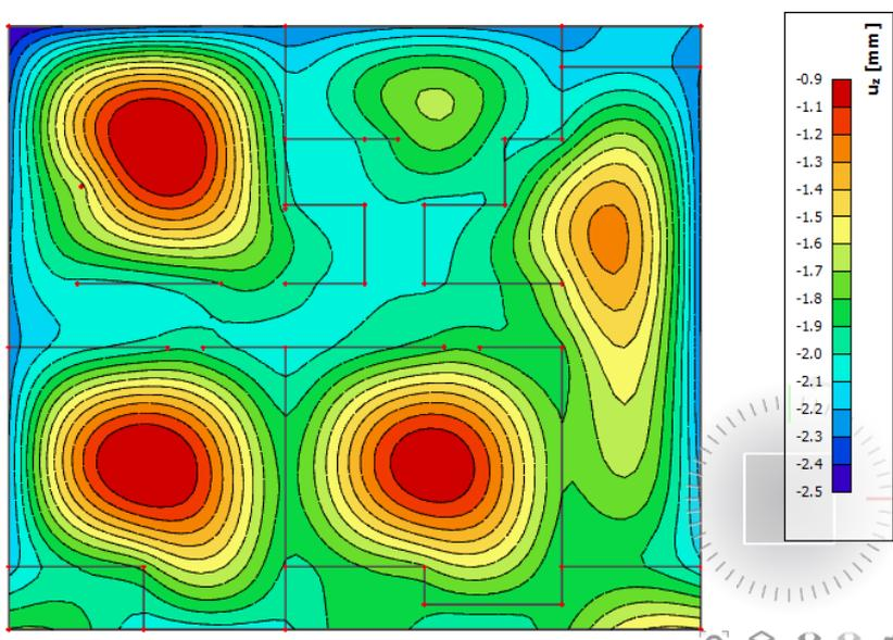
Slika 12.2. Progib ploče (mm) za kombinaciju GSU-2
