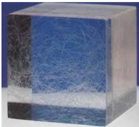
Slika 1. 3D raspored vlakana u betonu [5]
