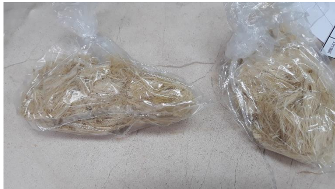
Slika 42. Izvagana vlakna brnistre ( 480g i 960g )
