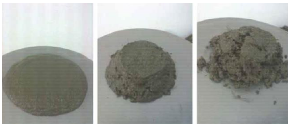
Slika 18. Obradivost morta bez vlakana, 0,5% vlakana, 1% vlakana [36]
