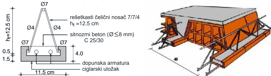
Slika 6.42 – Sustav Fert – Presjek kroz gredicu i aksonometrijski prikaz Fert stropa
