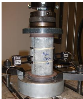
Slika 2.2 – Testiranje uzorka betona
