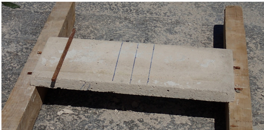
Foto 4.17: Priprema za opterećivanje poklopnice na posmičnu nosivost
