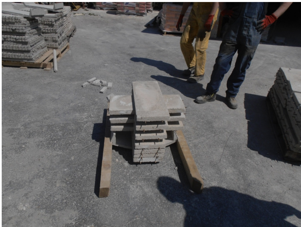
Foto 4.13: Provedba ispitivanja – kadica u položaju U
