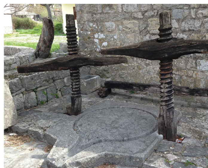
Grafički prilog 27. Dobro očuvana drvena građa turnja i kamena ploča koja prikuplja vino / fotografija autora analize
