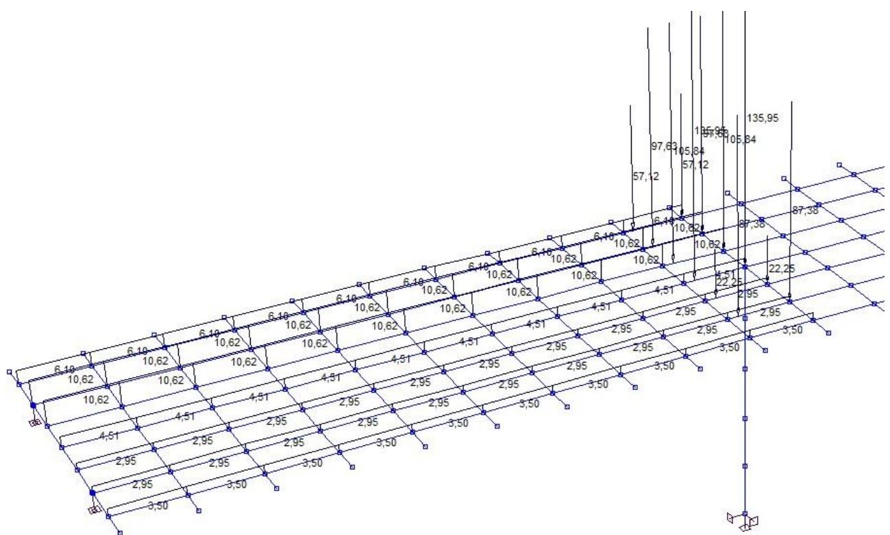
Slika 21: pokretno opterećenje za maksimalnu poprečnu silu pri stupu
