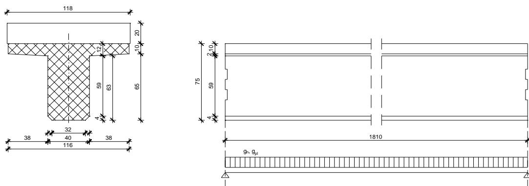
Slika 2. Uzdužna i poprečna dispozicija jednog nosača
