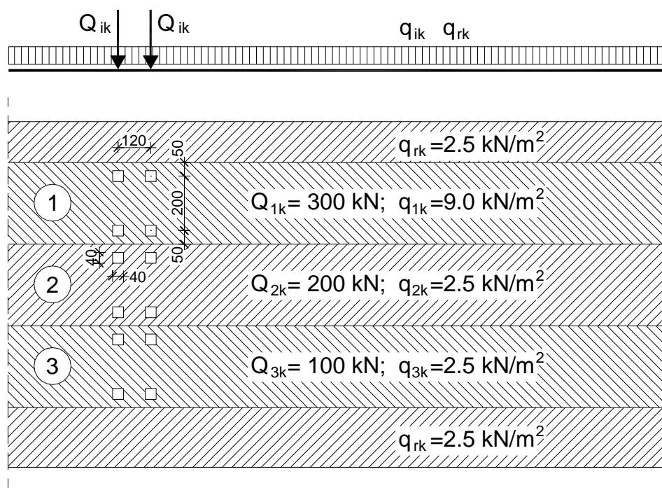
Slika 11: Prikaz načina opterećivanja mosta pokretnim opterećenjem
