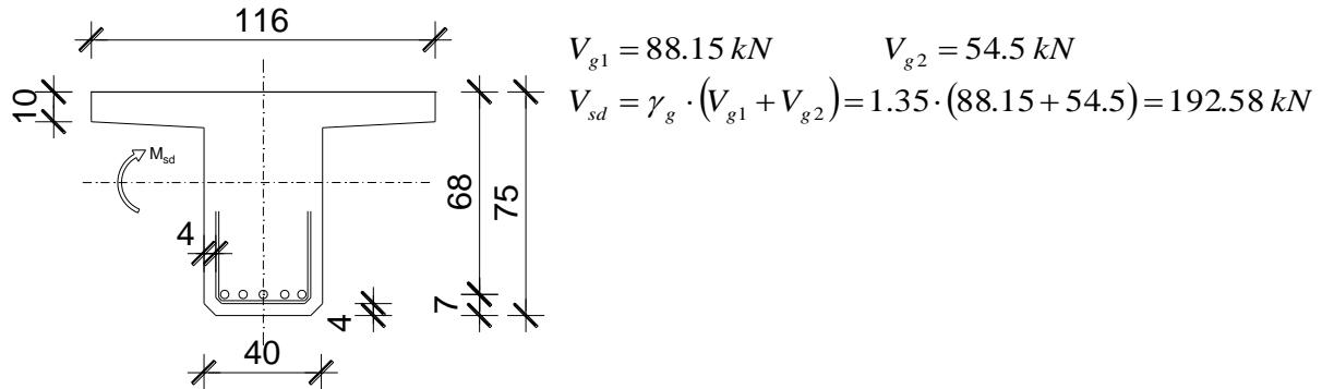
Dio poprečne sile koju preuzima beton i uzdužna armatura:
