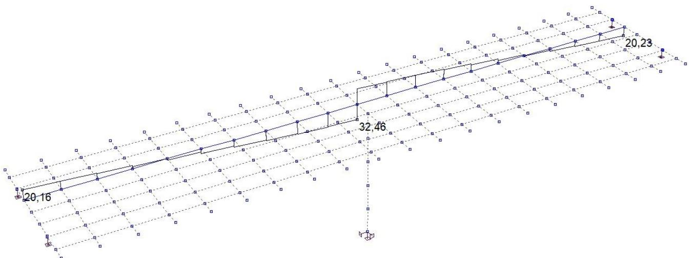
Slika 10: Dodatno stalno opterećenje – poprečne sile  $Tz$  (kN)
