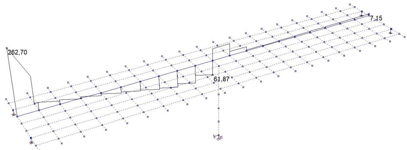
Slika 20: Pokretno opterećenje – maksimalne poprečne sile pri upornjaku – poprečne sile  $T_z$  (kN)
