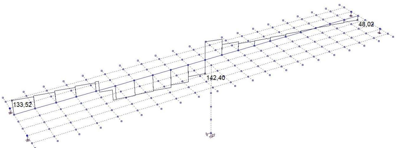
Slika 17: Pokretno opterećenje – maksimalni momenti pri stupu – poprečne sile  $T_z$  (kN)
