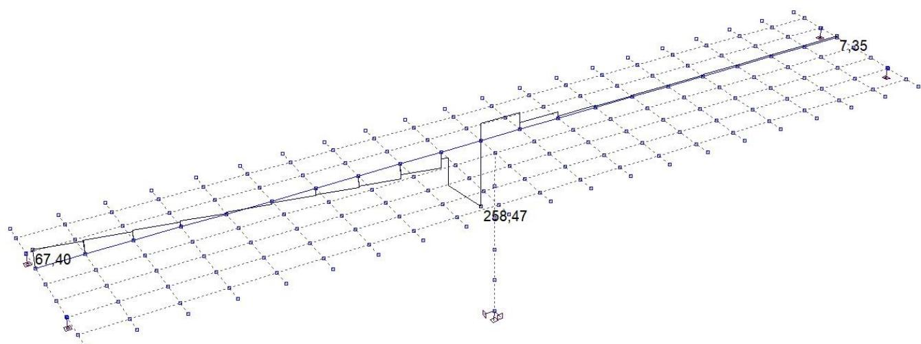
Slika 23: Pokretno opterećenje – maksimalne poprečne sile pri stupu – poprečne sile  $Tz$  (kN)
