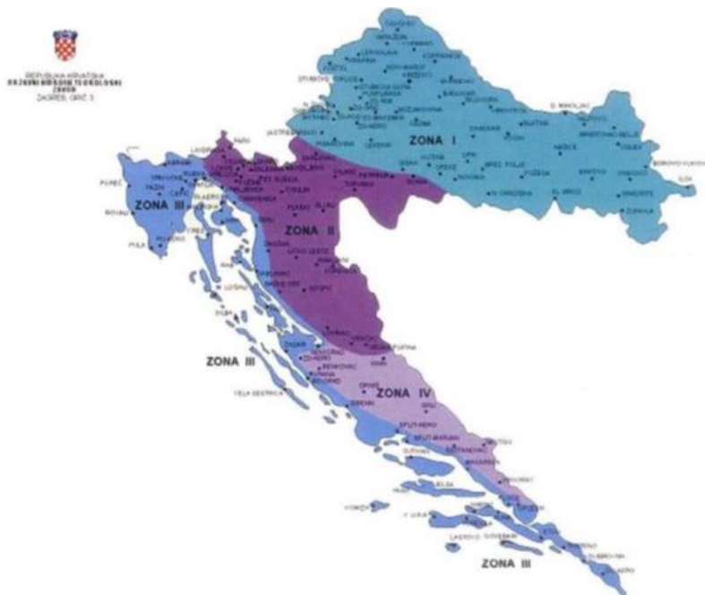
Slika 4.3. Klimatske zone karakterističnog opterećenja snijegom s_k (kN/m 2 )
