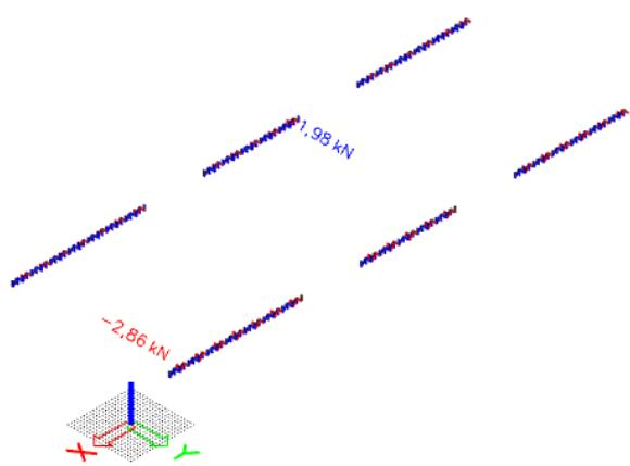
Slika 7.2.3.6.Poprečna sila  $V_y$
