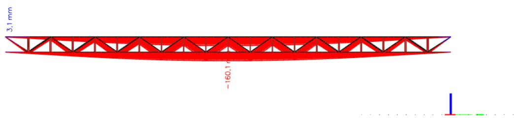
Slika 6.2.1. Vertikalni pomak rešetke u smjeru osi z
