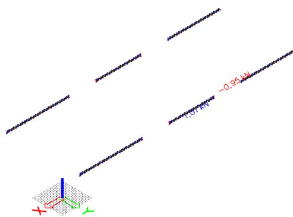
Slika 7.2.3.7.Poprečna sila  $V_z$
