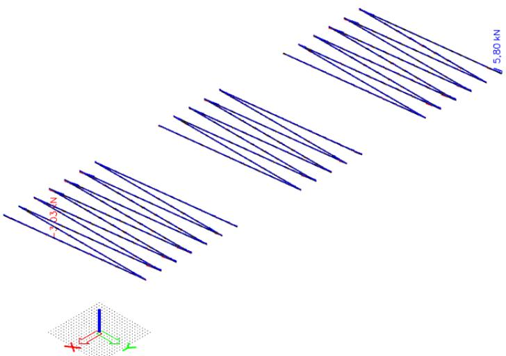
Slika 7.1.1.7.Poprečna sila  $V_z$
