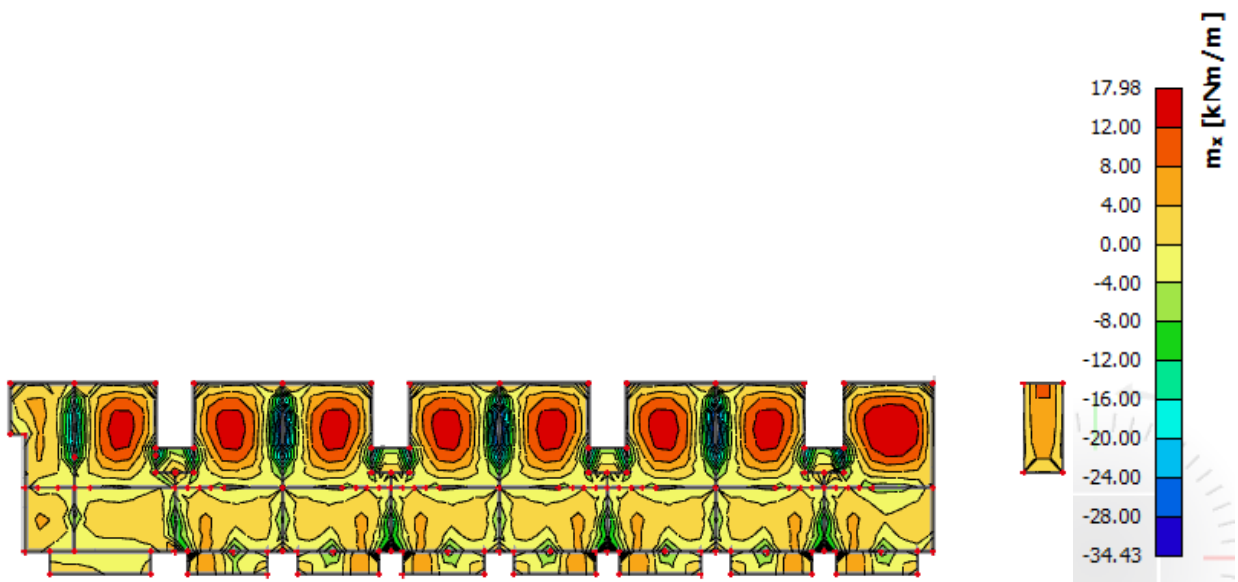
Slika 11.37. Rezultati momenata savijanja ploče pozicije 300 (GSN 2, M_x )
