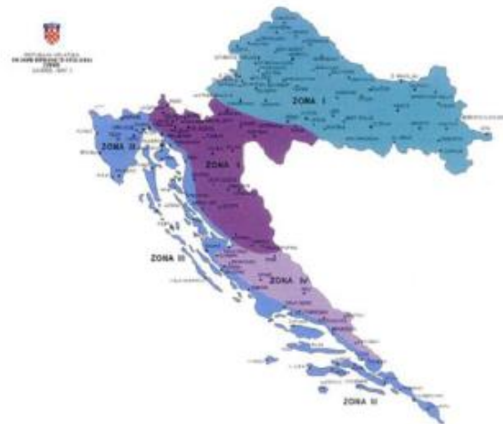
Slika 5.6. Klimatske zone karakterističnog opterećenja snijegom na tlu S_k za RH
