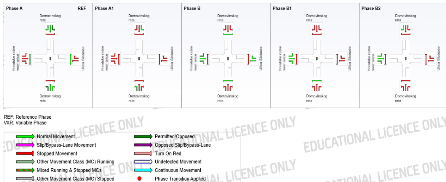
Slika 33. Prikaz svih faza ciklusa i mogućih kretnji unutar raskrižja
