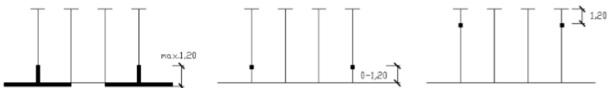
Slika 2. Odnos položaja stupa/nosivog zida i parkirnog mjesta, [2]
