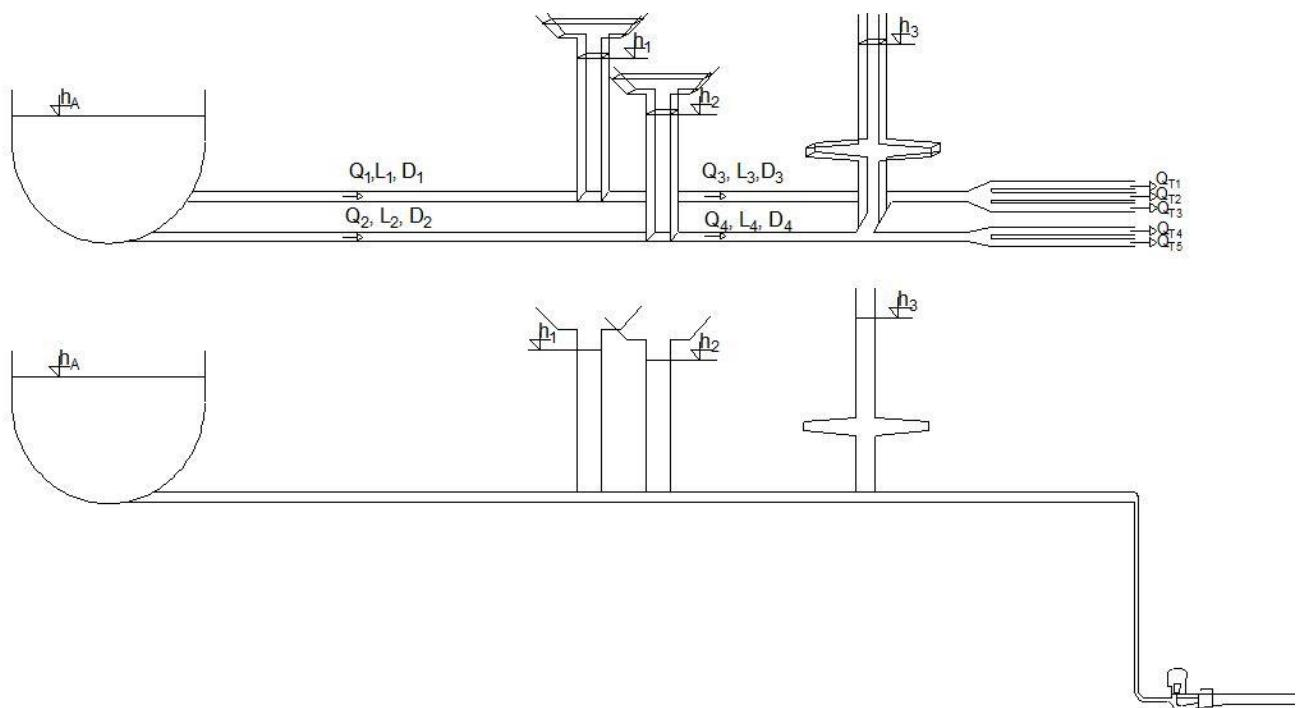
Slika 2 Skica sustava hidroelektrane
