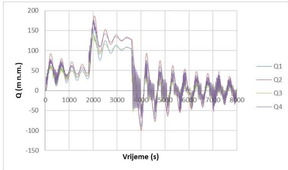
*Slika 120* Protoci u dovodnim tunelima 1, 2, 3 i 4 u ovisnosti o vremenu za Varijantu 5.2
