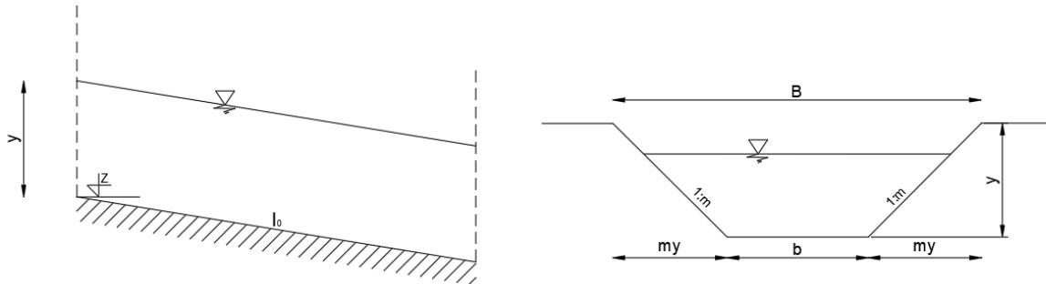
Slika 6 Uzdužni i poprečni presjek korita
