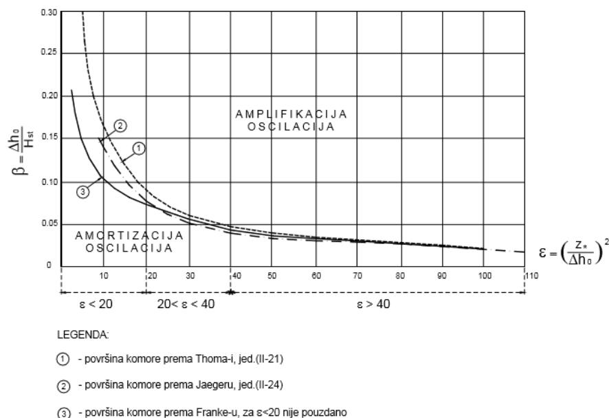
*Slika 1* Dijagram za određivanje stabilnosti cilindrične vodne komore
